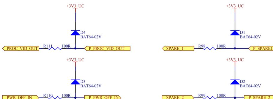
Figura 5-25. Esquema eléctrico líneas discretas.
