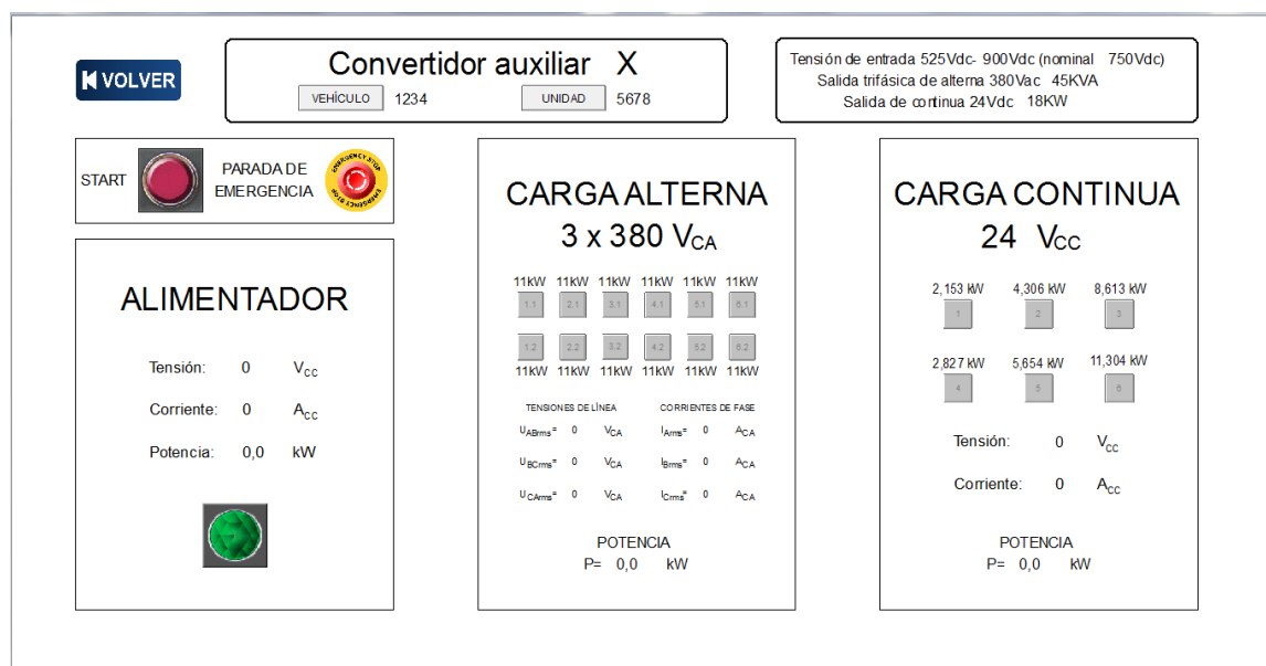
Figura 36. Pantalla monitorización Convertidor Genérico .
