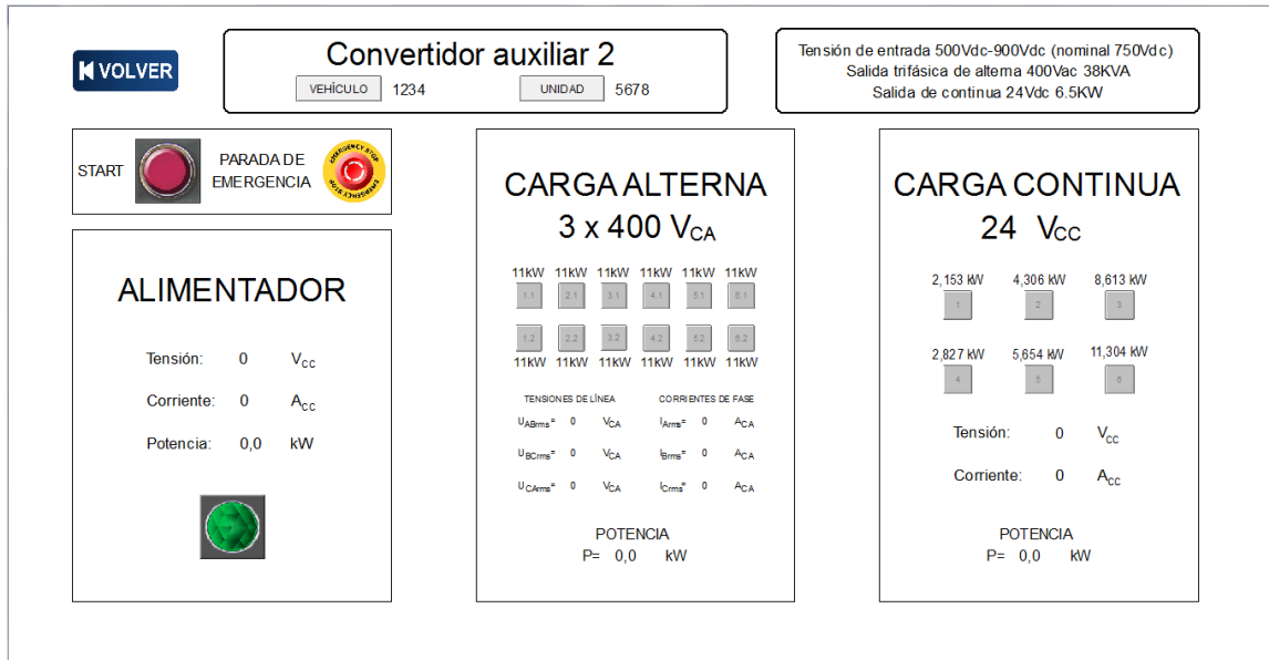
Figura 31. Pantalla monitorización Convertidor auxiliar 2 .
