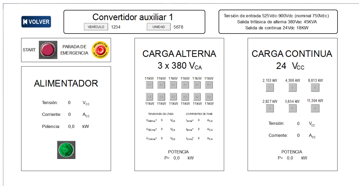
Figura 30. Pantalla monitorización Convertidor auxiliar 1 .
