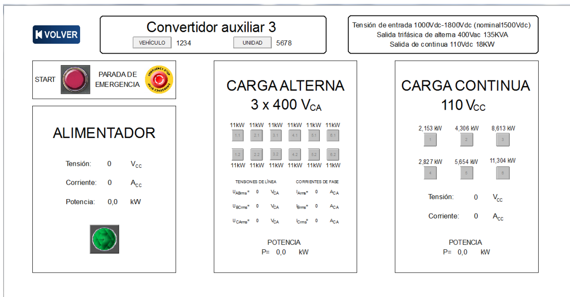
Figura 32. Pantalla monitorización Convertidor auxiliar 3 .
