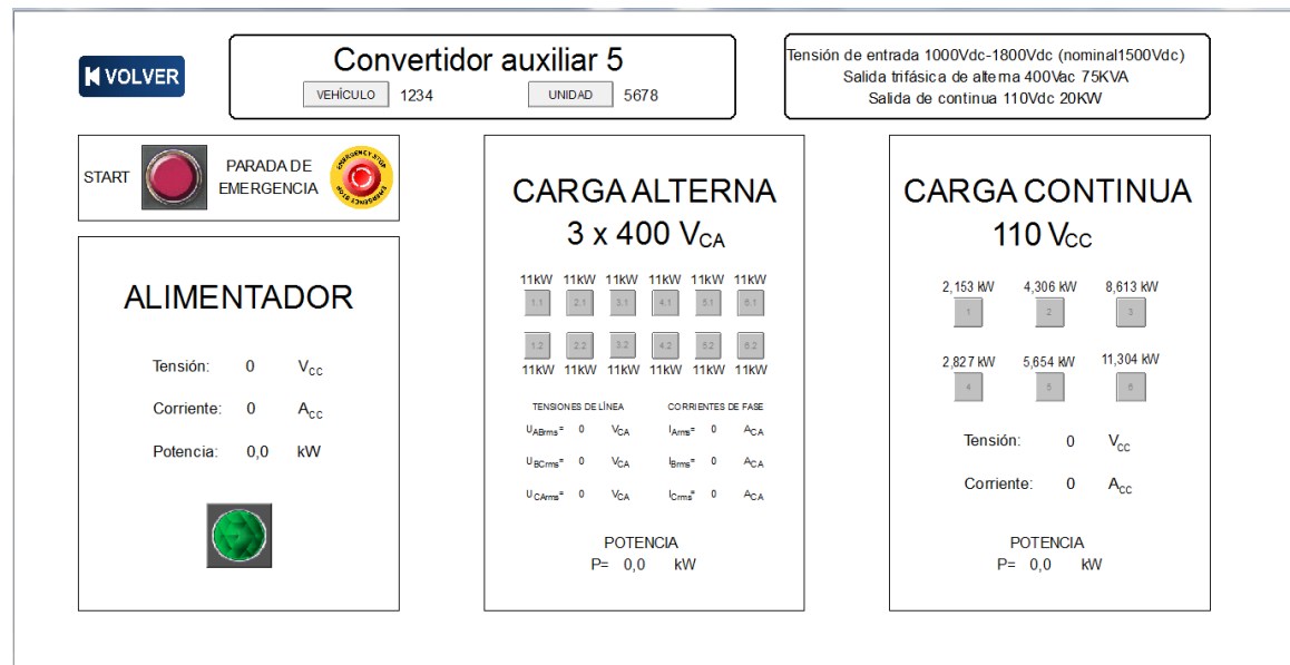
Figura 34. Pantalla monitorización Convertidor auxiliar 5 .
