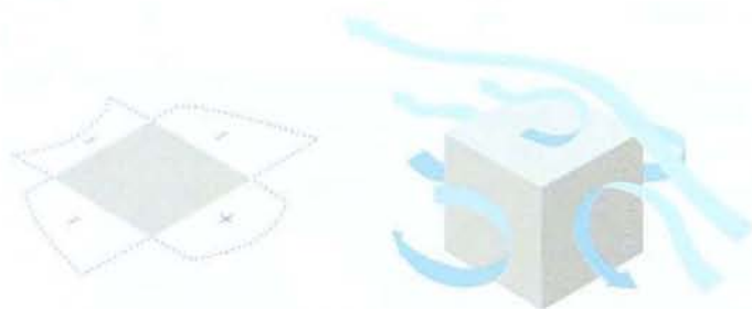
EFECTO DE VIENTO SOBRE UN VOLUMEN PRISMÁTICO; CARAS CON SOBRE Y BAJO PRESIÓN
