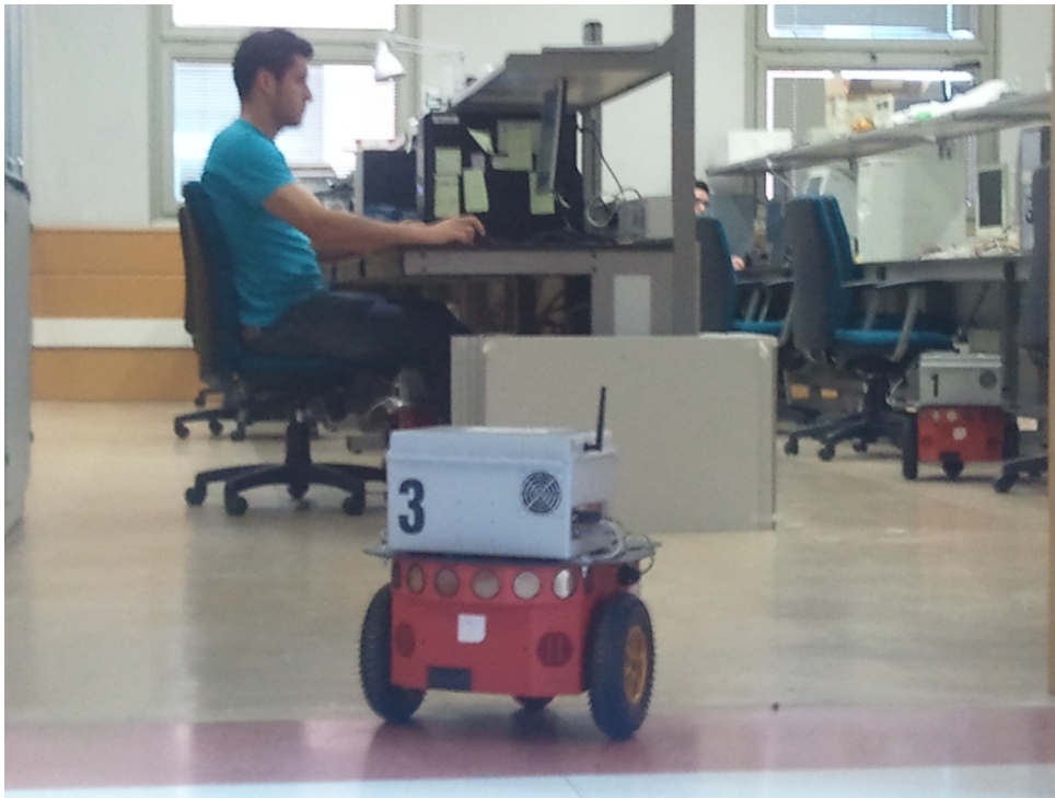
Figura 3.4: Robot P3-DX y centro remoto aplicando la solución de STC adaptativo propuesto.
