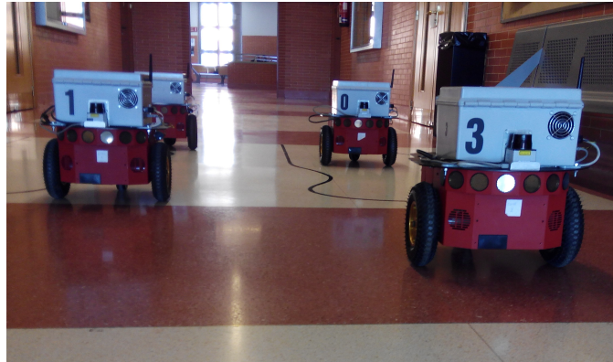
Figura 4.11: Ensayos experimentales con cuatro unidades robóticas P3-DX controladas de forma remota por un PC aplicando un STC para compensar los retardos del canal.
