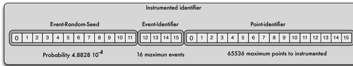
Figura 6.8: Campos que conforman un punto de instrumentación. Esta propuesta permite demultiplexar los diferentes eventos y puntos en el código fuente, de tal manera que habilita la verificación propuesta.
