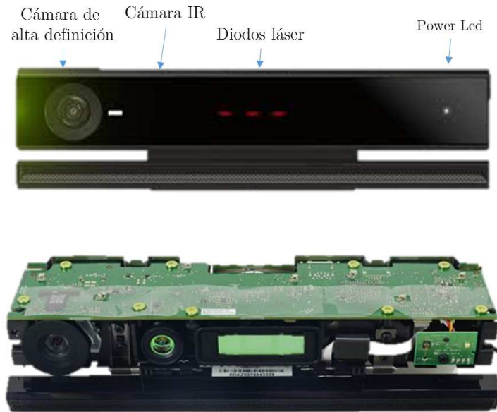
Figura 4.2: Detalle del sensor utilizado (Kinect 2).
