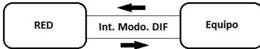
Figura 2.8 – Interferencias en modo diferencial
