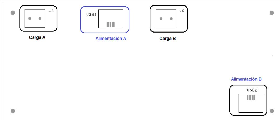
Figura 4.2 – Ubicación de componentes de alimentación y carga
