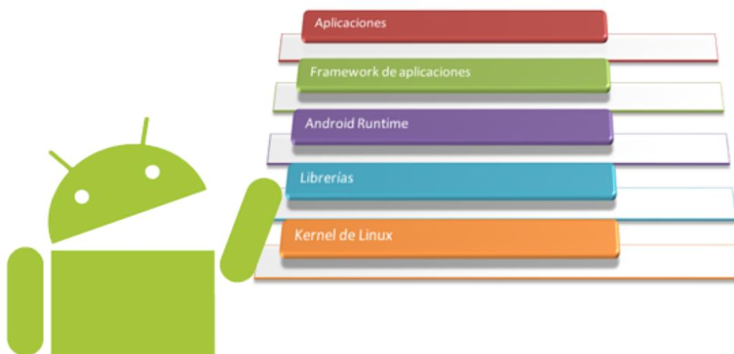
El núcleo Android está basado en la arquitectura Linux, proporcionando de esta manera servicios como seguridad, acceso a memoria, multiproceso o drivers de dispositivos, es una capa de abstracción dependiente por tanto del software.
