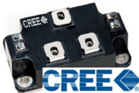
Figura 1 Módulo SiC de Cree, 100A 1200V
