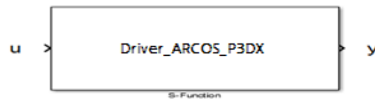
Ilustración 3.37: S-Function con el driver creado mediante la interfaz ARCOS.
