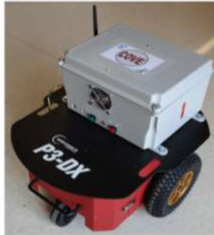
Ilustración 3.3: Montaje interior de la caja y plataforma P3-DX utilizada.
