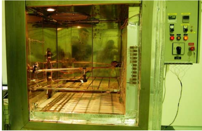
Figura. 5.16 Detalle de montaje del instrumento durante el Test de Ciclado Térmico
