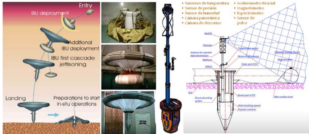
Figura. 1.3 De izquierda a derecha: concepto EDL (Entry, Descent and Landing) en MetNet, diversas imágenes del hardware real, y diagrama de la estación meteorológica una vez desplegada
