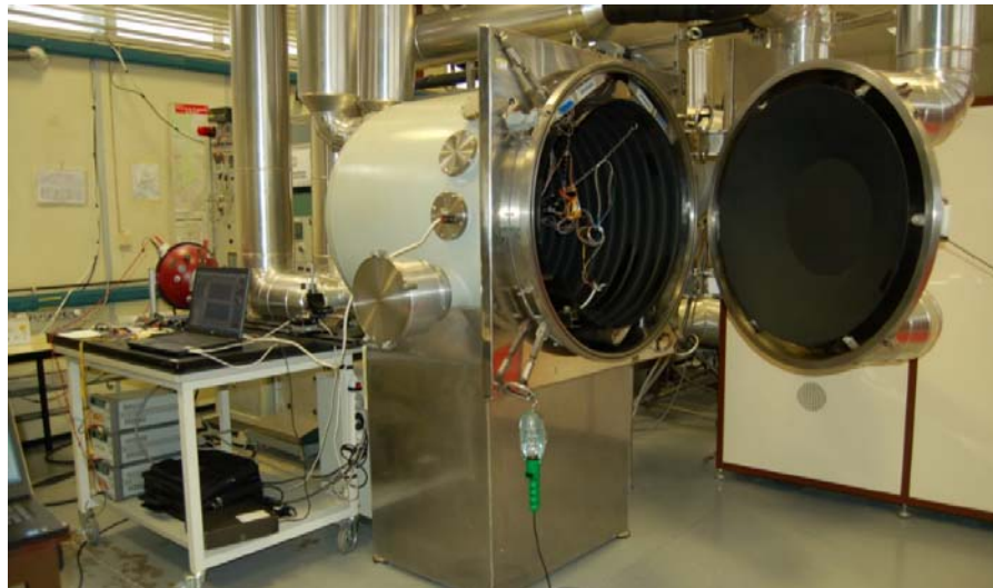
Figura. 5.24 Detalle de montaje del instrumento durante el Test de Vacío Térmico
