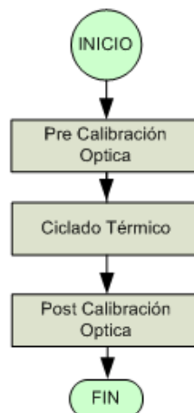
Figura. 5.14 Diagrama de flujo simplificado del Test de Ciclado Térmico
