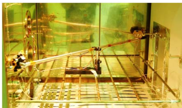
Figura. 5.13 Detalle de montaje del instrumento en el mástil durante el Test de Ciclado Térmico
