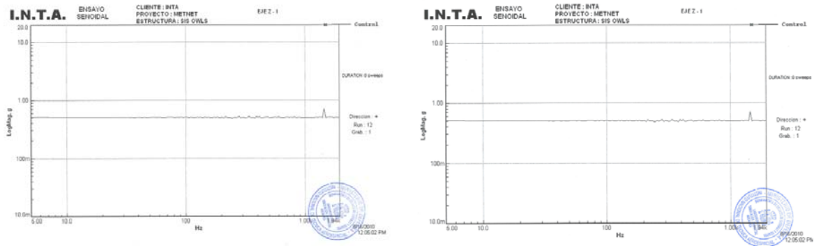
Figura. 5.9 Firma mecánica antes y después del Test de Vibración en el eje Z – Test de Vibración
