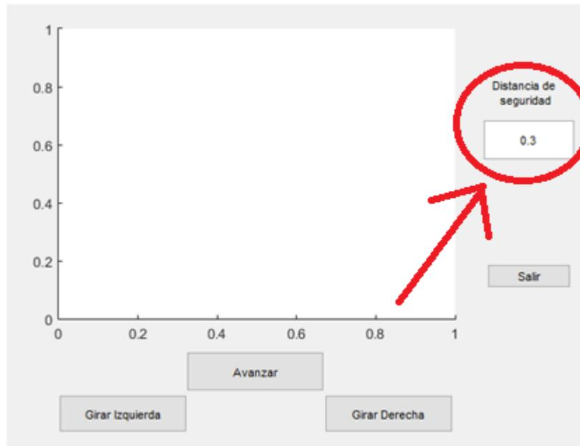
Ilustración 33 Cuadro para cambiar la distancia de seguridad
