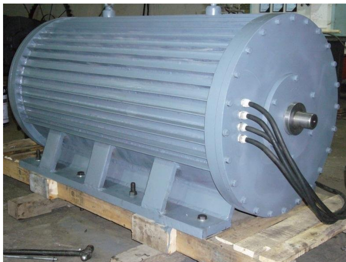
Figura 2.7. Generador síncrono de imanes permanentes de 1MW.
