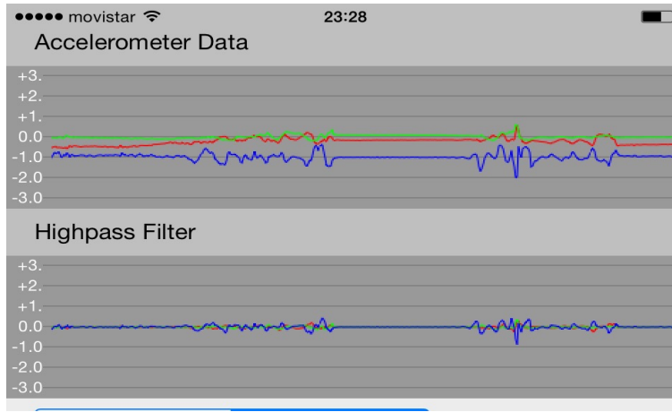
Figura 3.1: Datos del acelerómetro reales vs. datos pasado por el filtro paso alto
