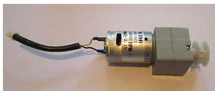
Figura 2.9. Motor empleado para mover la cinta
