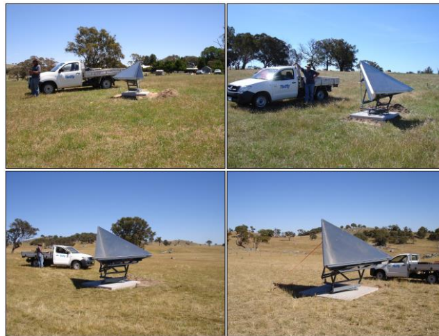
Imagen 9: Instalación de varios CR
