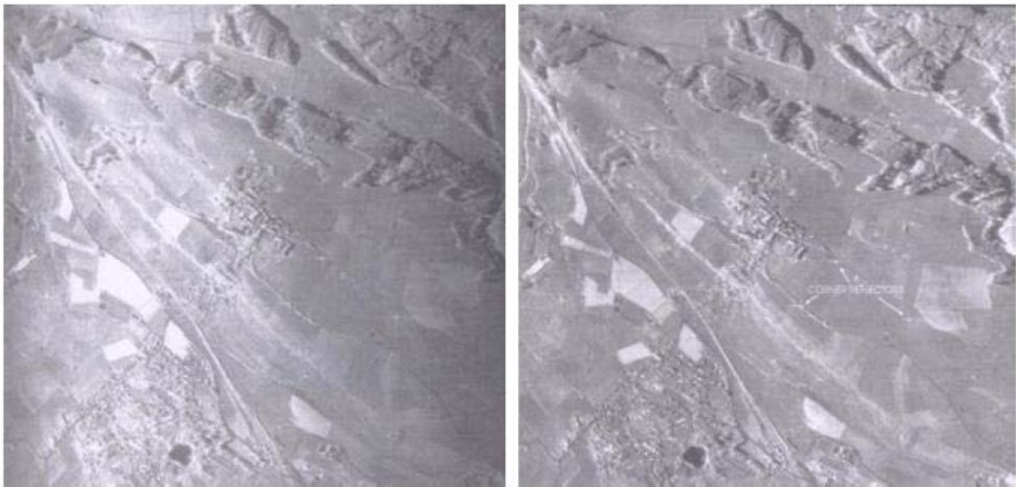
Imagen 3: Imagen antes y después de la calibración radiométrica
