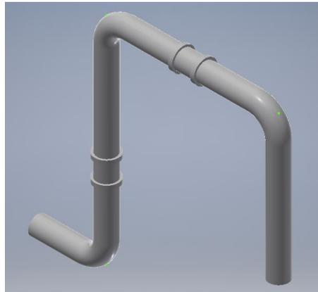
Ilustración 496. Aplicación del comando Llenar Enrutamiento I. Conducto de Tubería.
