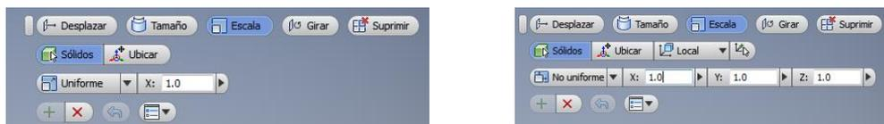
Ilustración 258. Barra de herramientas del comando Edición Directa - Escala. Entorno Impresión 3D.
