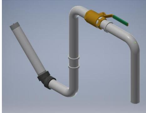
Ilustración 503. Aplicación del comando Llenar Enrutamiento II. Conducto de Tubería.
