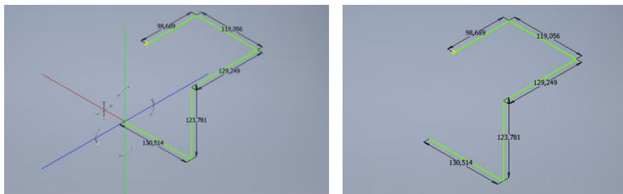
Ilustración 296. Final del proceso del enrutamiento manual. Entorno Tubos y Tuberías.
