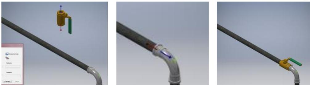
Ilustración 316. Ejemplo de conexión de accesorios sobre conexión del conducto II. Entorno Tubos y Tuberías.
