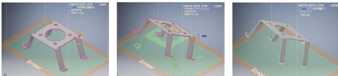
Ilustración 255. Proceso de Rotación mediante Orientación Local. Entorno Impresión 3D.
