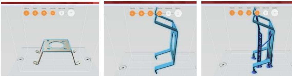
Ilustración 278. Generación de soportes de forma automática en Print Studio. Entorno Impresión 3D.
