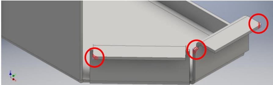
Ilustración 139. Ejemplo de configuración esquina. Redondeo de esquinas. Modificar.
