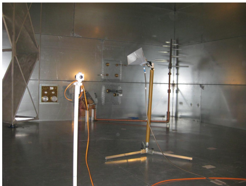
Figura 4.1: Validación de la cámara reverberante del INTA.
