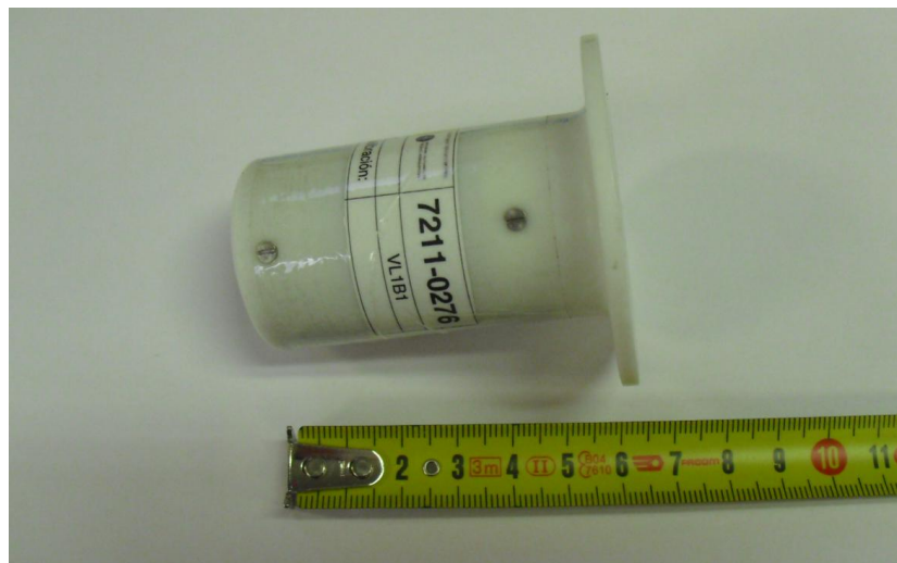
Figura 4.21: Antena receptora utilizada en las medidas.
