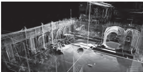
Figura 03: Imagen realizada por Dña. Concepción López González, Nube de puntos resultado de la unión de los distintos escaneados del Patio Sur de San Juan del Hospital (2014).
