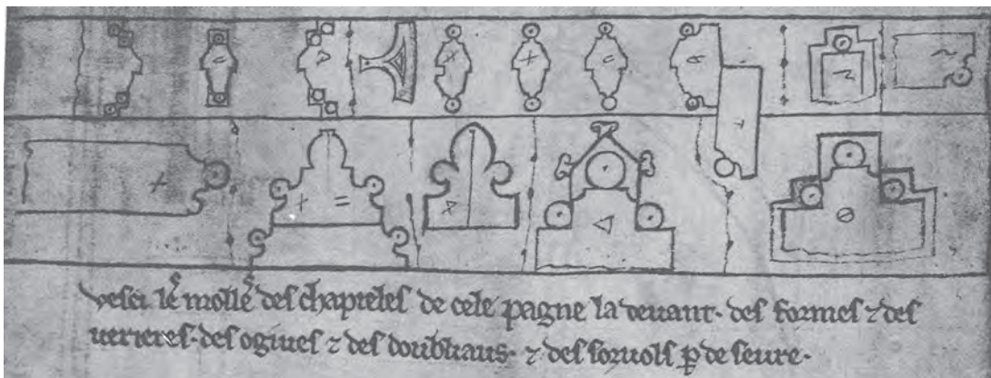
Figura 01. Detalle del folio 32 del Album de Villard de Honnecourt, con dibujos de detalles del corte de piedras para la catedral de Reims. En la imagen, según leyenda: “He aquí las plantillas de las capillas de esta página, las de los vanos y las cristalerías, de las ojivas, de los perpiños, y más arriba, las de los formeros.” (Villar de Honnecourt. [Siglo XIII] 1991, lámina 63, traducción p. 138)
