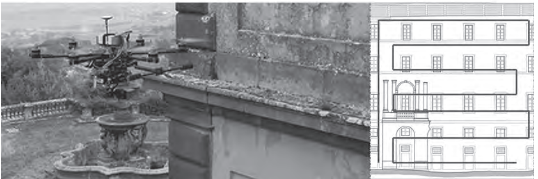
Figura 05. Programa di volo (in alto), drone DJI A2 equipaggiato con GoPro Hero 3+ (in basso a sinistra), percorso di volo (in basso a destra).
