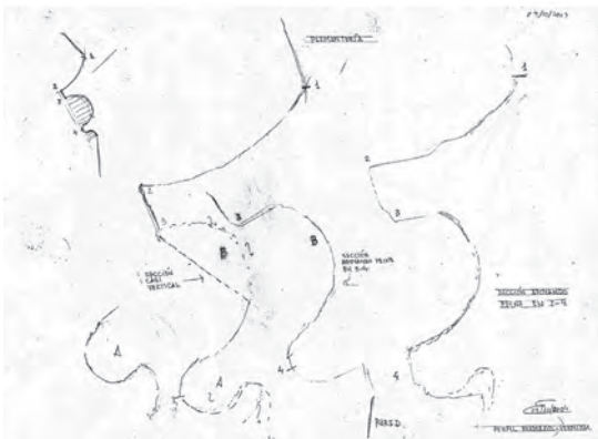
Figura 06. Perfiles de los arcos formeros obtenidos con varias tomas mediante el perfilómetro. (Esther Capilla. 29-10-2004).
