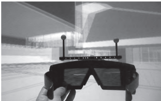
Figura 07. Las gafas cuentan con dispositivos que permiten identificar la posición y la orientación del observador, actualizando en tiempo real las imágenes proyectadas sobre las pantallas.
