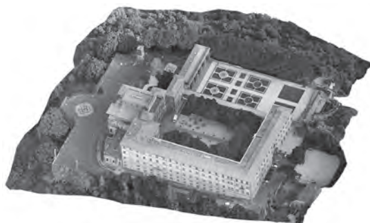
Figura 07. Modello a nuvola di punti ottenuto con fotogrammetria digitale aerea.
