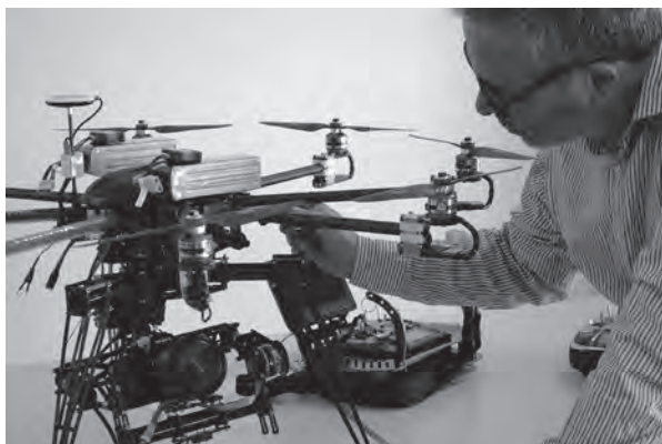
Figura 05. Drone de ocho rotores. Realización de la lista de verificación previa al transporte al lugar del vuelo.
