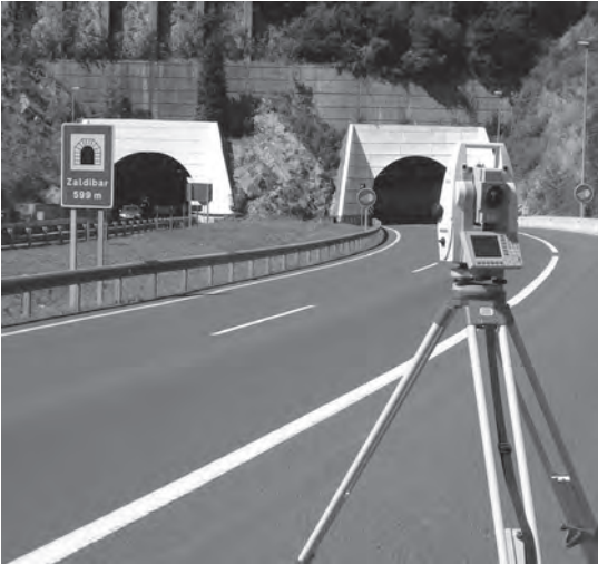
Figuras 03 y 04: Equipos de GPS y Estación Total utilizados para realizar levantamientos por topografía clásica. Elaboración propia.
