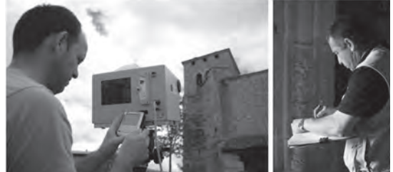
Figura 08. Toma de datos con escáner y croquización
