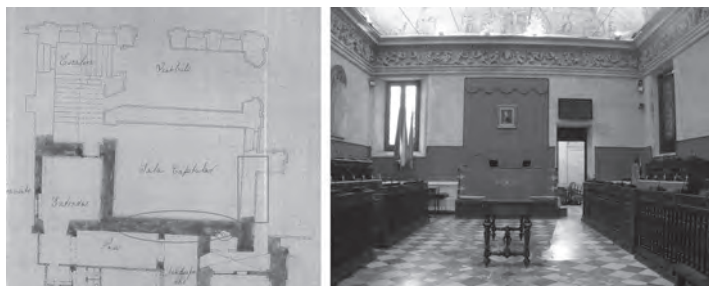
Figura 08. a) Anónimo Proyecto de traslado secretaria 1864 Detalle de la Sala capitular Baja (A.M.S. Sección Alfabética 191, Exp. 19). Muros sur y oeste de la Sala Capitular donde se en 1929 se abrieron una puerta y dos ventanas. b) Sala capitular Baja. Fotografía de autor. 2005
