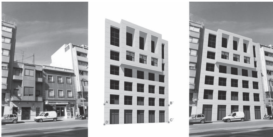
Figura 07. Transformación homográfica de la foto-perspectiva "estirándola" homográficamente hasta que los puntos A, B, C y D coincidan con sus homólogos A', B', C' y D'.
