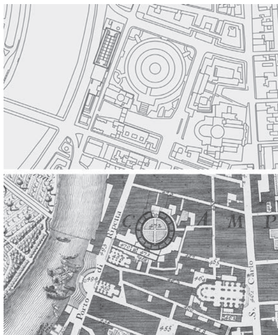
Figura 05. L'area di Piazza Augusto Imperatore tra via Ripetta e via del Corso. Confronto tra la planimetria attuale con la carta storica del Nolli del 1748. Emergono le trasformazioni urbane avvenute: l'invaso della piazza e l'isolamento del mausoleo, la demolizione del porto di Ripetta, la costruzione dei nuovi argini e dei muraglioni del fiume.
