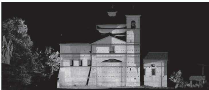
Figura 02. Scansione Laser della Chiesa
