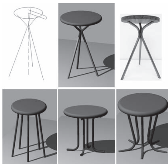
Figura 03. Estructura, modelo virtual, modelo real y variantes paramétricas para el diseño de un taburete.
