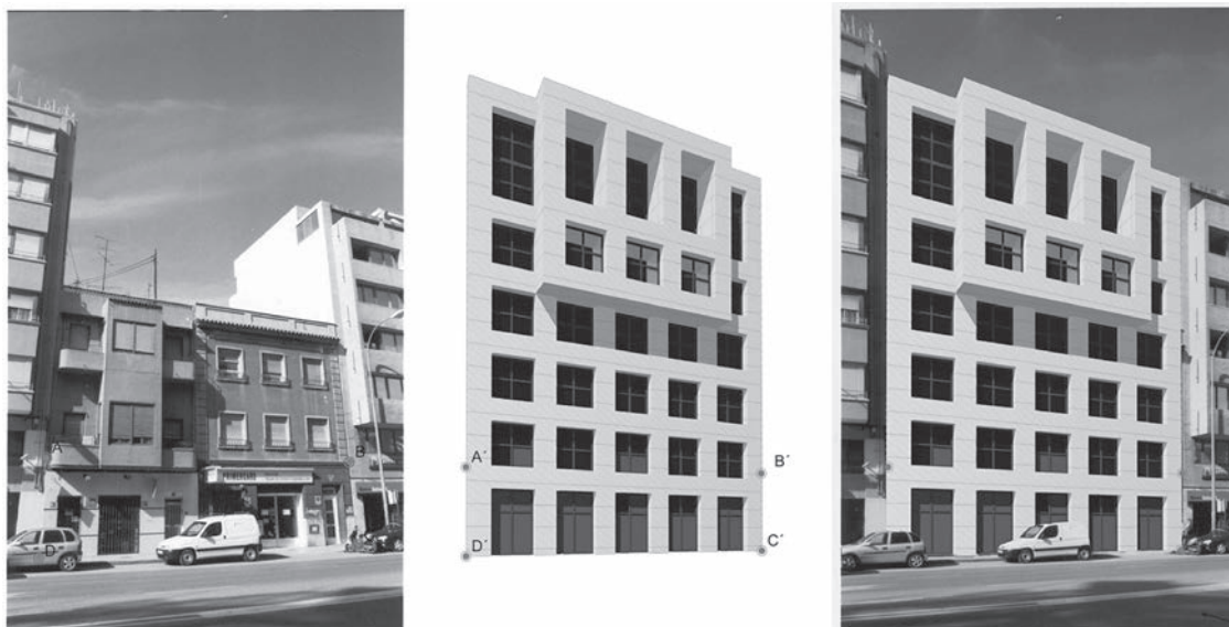
Figura 06. Transformación homográfica de la instantánea del entorno “estirando” homográficamente la imagen del entorno hasta que los puntos A, B, C y D coincidan con sus homólogos A', B', C', D'.
