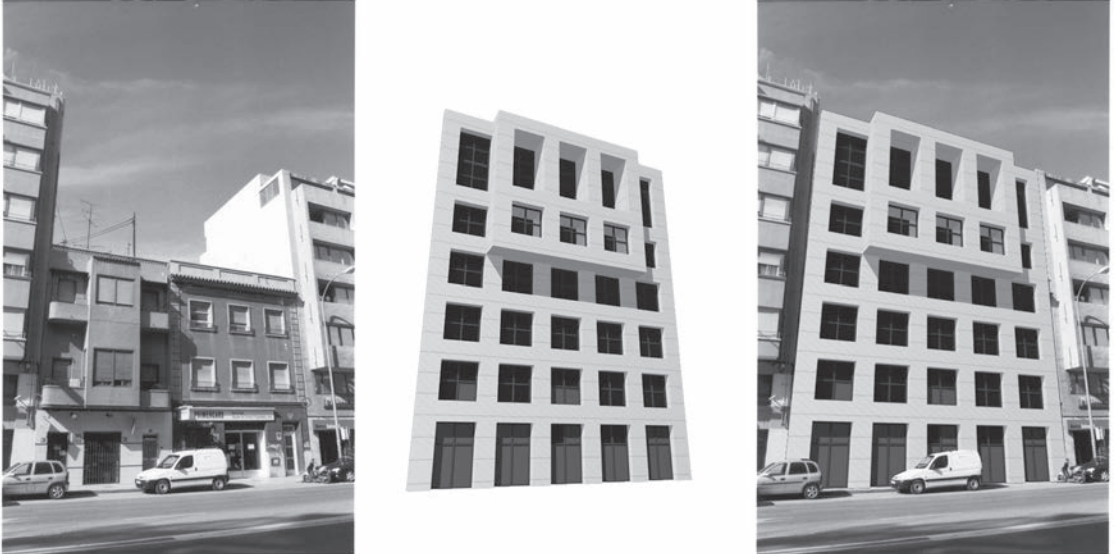
Figura 03. Método tradicional de fotomontaje. Caso particular con plano de cuadro inclinado. La fotografía de la realidad y la fotografía del modelo virtual deben coincidir idénticamente para poder superponerse.
