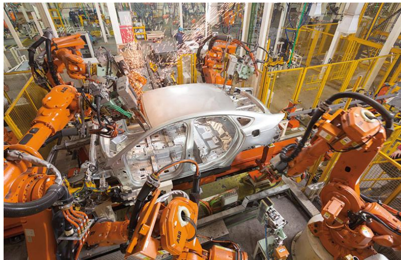
FIGURA 2.2 Robots industriales de ABB en cadena de producción
