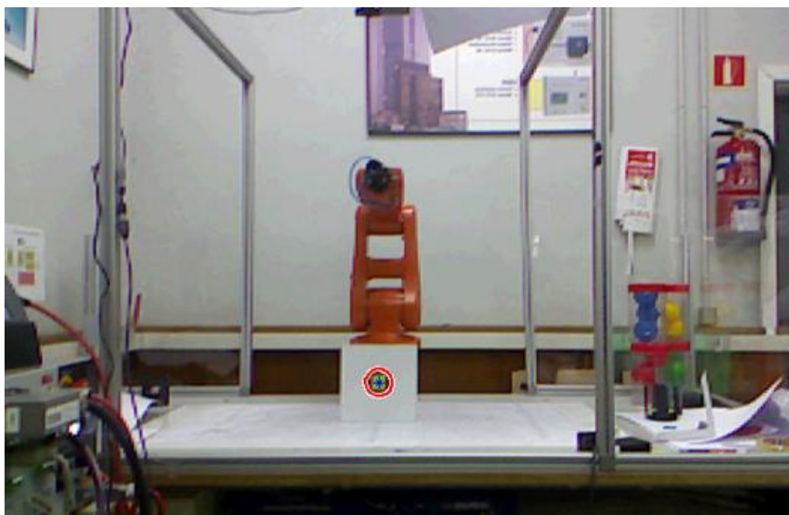
FIGURA 4.5 Calibración automática y detección de blancos mediante sensor Kinect
