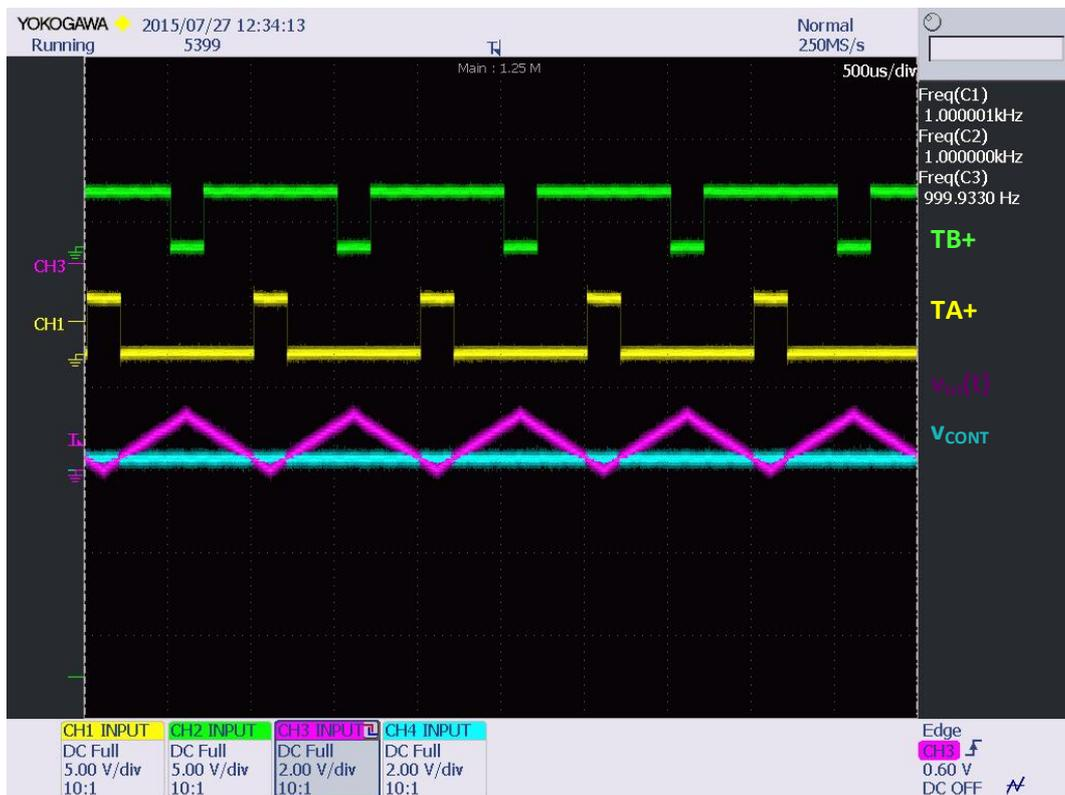
Figura 123 Señal de salida de la FPGA para un ciclo de trabajo de D=0,2
