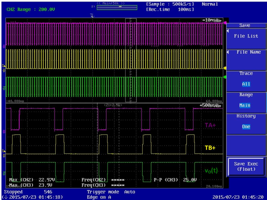
Figura 143 Señales simulación puente en H para un ciclo de trabajo D=0,8.
