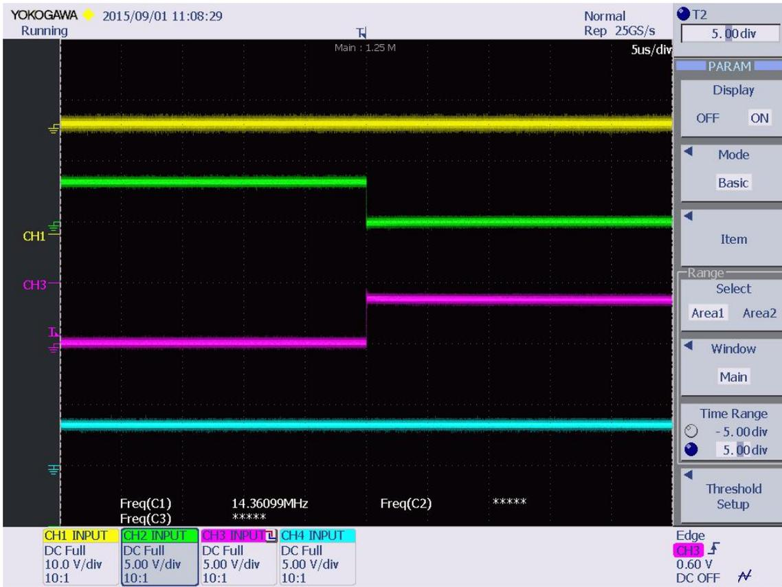
Figura 132 Señal de salida del circuito de adaptación sin tiempos muertos
