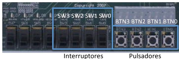
Figura 149 Identificación de interruptores y pulsadores en la FPGA.
