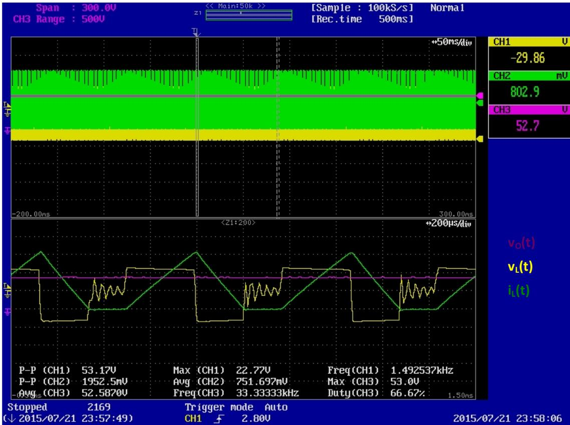
Figura 107 Señales reales elevador en MCD para un ciclo de trabajo D=0,6.
