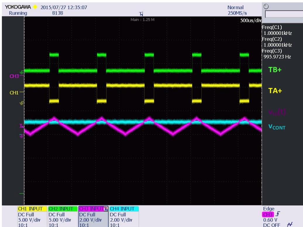
Figura 128 Señal de salida de la FPGA para un ciclo de trabajo de D=0,8
