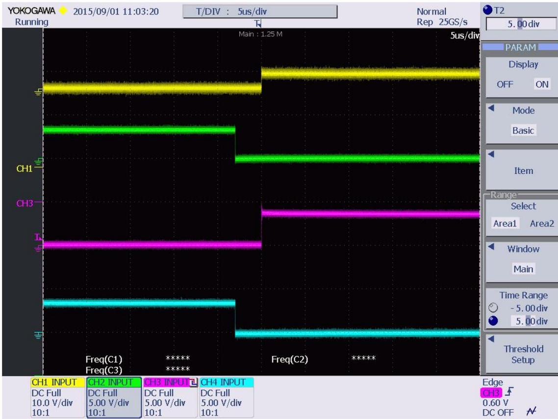
Figura 134 Señal de salida del circuito de adaptación con tiempos muertos de 3µs.
