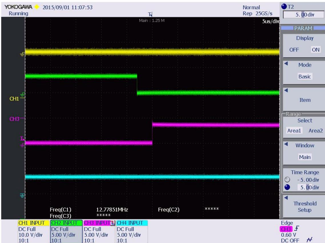
Figura 131 Señal de salida del circuito de adaptación con tiempo muerto de 3µs.
