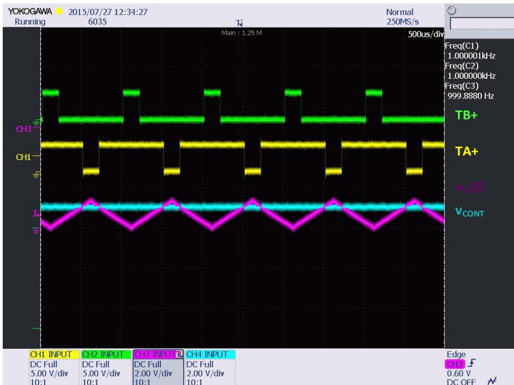
Figura 125 Señal de salida de la FPGA para un ciclo de trabajo de D=0,8
