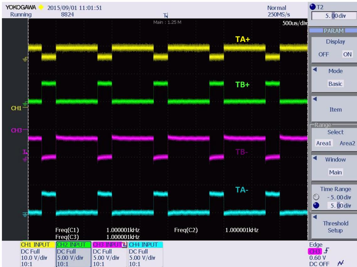
Figura 133 Señal de salida del circuito de adaptación con un ciclo de trabajo D=0,75.
