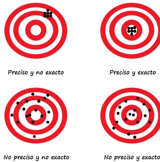
Figura 1.8: Diferencia entre precisión y exactitud de la medida
