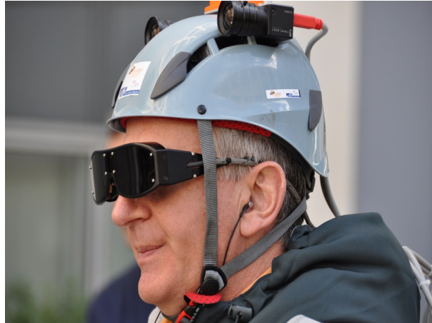
Figura 1.1: Gafas biónicas basadas en visión artificial para personas con problemas de visión.
