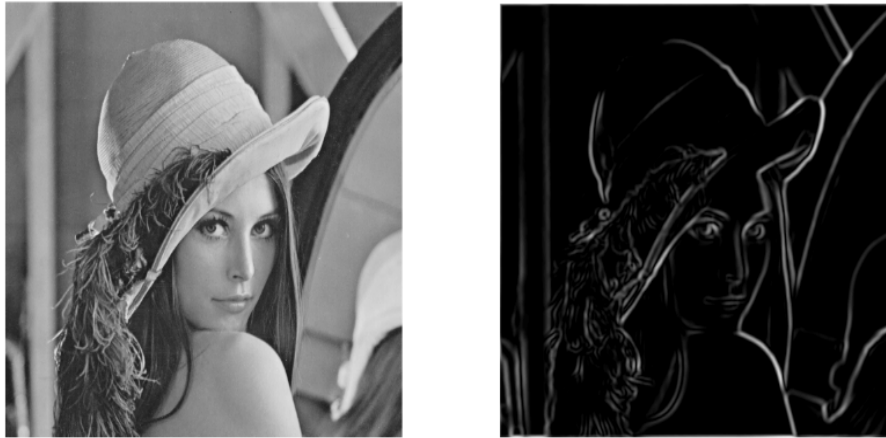
Figura 2.4: Ejemplo de detección de bordes en una imagen haciendo uso del método Canny.
