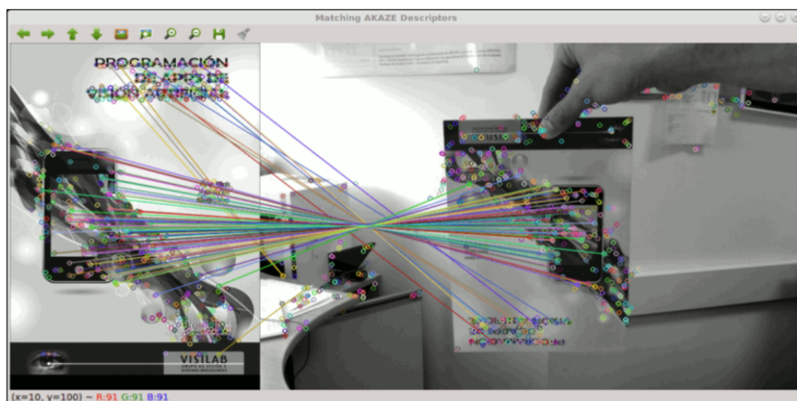
Figura 2.8: Ejemplo de matching o correspondencia entre descriptores AKAZE.
