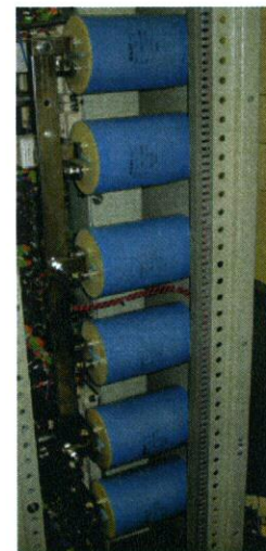
Fig. 3.5. Filtro de red LCL: a) Esquema del filtro. b) Imagen del filtro real.
