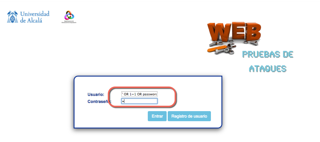
Figura 21 – Datos entrada Prueba inyección 2
