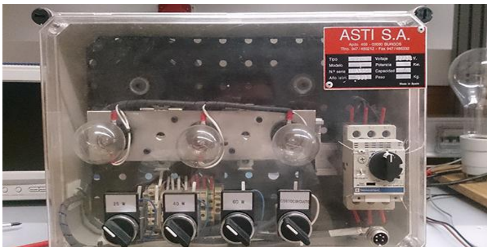
Figura 3.11 Sistema motor-generator ASTI BECA 1.
