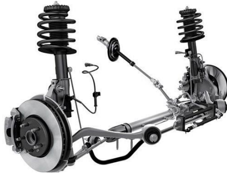
Figura 2.35. Suspensión MacPherson aplicada al eje delantero.
