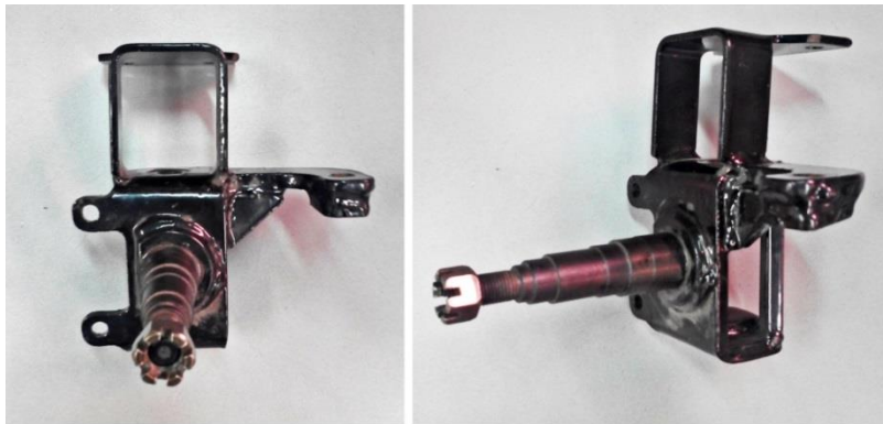
Figura 3.39. Alzado (izda.) y perfil (drcha.) de la mangueta.
