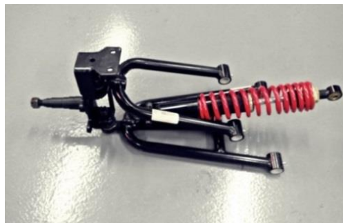
Figura 3.73. Fijación de los trapecios con la mangueta y el amortiguador.
