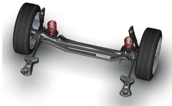
Figura 2.32. Suspensión de brazos tirados en el eje trasero.
