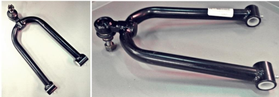
Figura 3.35. Vista frontal (izda.) y posterior (drcha.) del trapecio superior.
