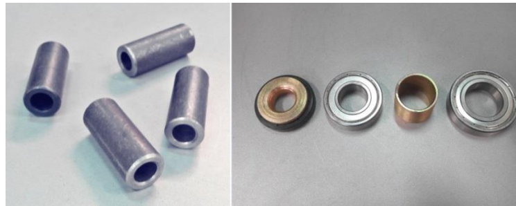
Figura 3.49. Casquillos de los trapecios superior e inferior (izda.) y elementos internos del buje (drcha.)
