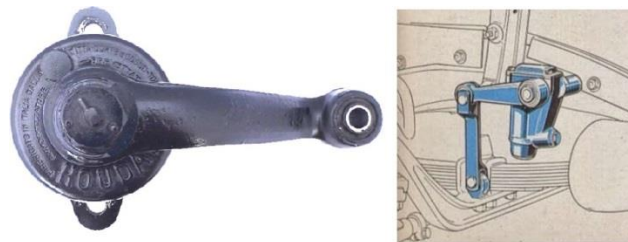
Figura 2.17. Amortiguador giratorio (izda.) y de pistón (drcha.). 9
