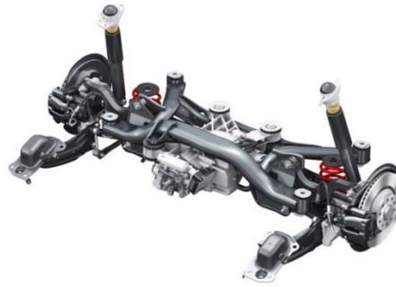
Figura 2.40. Suspensión multibrazo con brazos de guía longitudinal.
