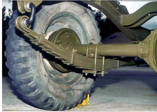
Figura 2.8. Ballesta fijada longitudinalmente en un vehículo industrial.
