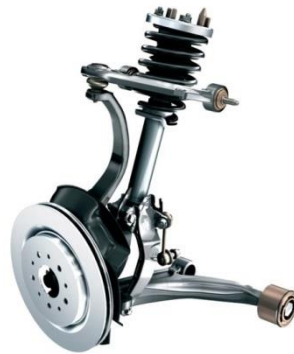
Figura 2.38. Suspensión multibrazo o multilink.
