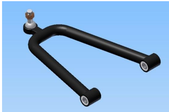
Figura 3.36. Diseño completo del trapecio superior.
