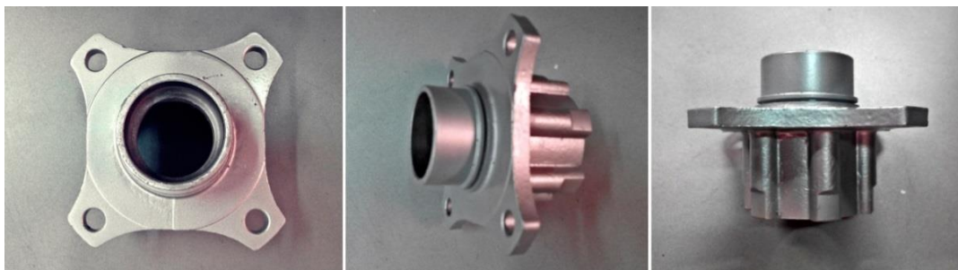
Figura 3.37. Alzado (izda.), perfil (centro) y planta (drcha.) del buje.
