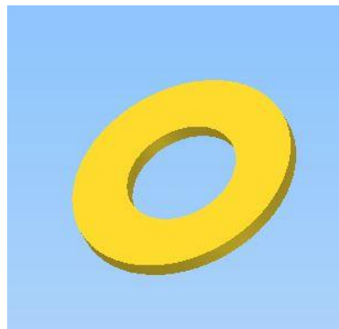
Figura 3.55. Diseño de la arandela de la parte superior del amortiguador.
