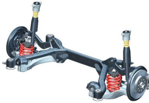
Figura 2.33. Composición del sistema de suspensión de brazos tirados.
