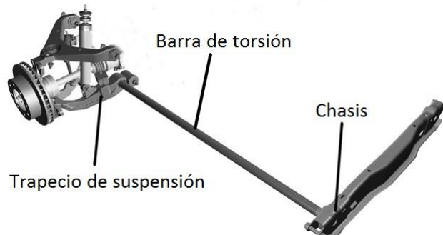
Figura 2.10. Fijación de la barra de torsión entre el trapecio y el chasis.
