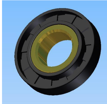
Figura 3.64. Diseño del tope de sujeción del buje con la mangueta.
