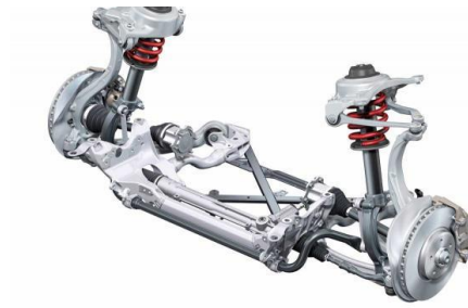
Figura 2.39. Suspensión multibrazo con elementos guía transversales u oblicuos.
