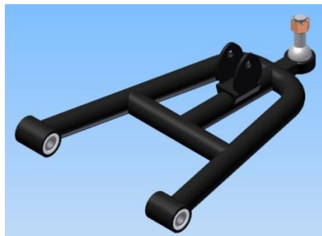
Figura 3.30. Diseño final del trapecio de suspensión inferior.
