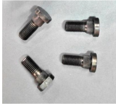
Figura 3.52. Pernos de sujeción del buje con la llanta.
