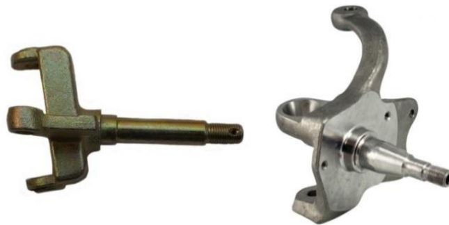
Figura 2.23. Eje (izda.) y cuerpo (drcha.) de la mangueta.
