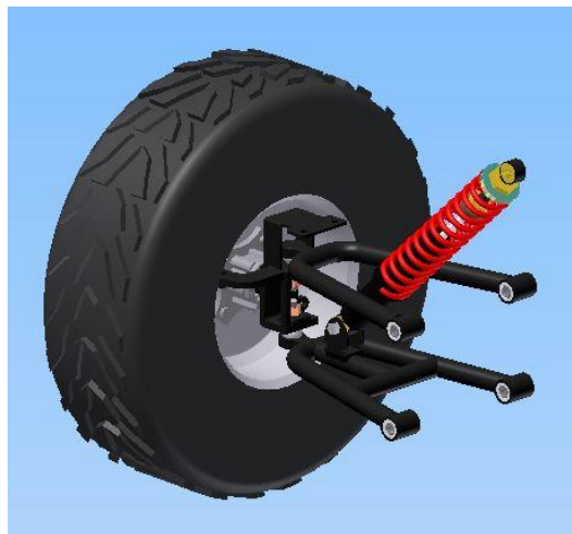
Figura 3.76. Ensamblaje de la rueda y los elementos de suspensión.
