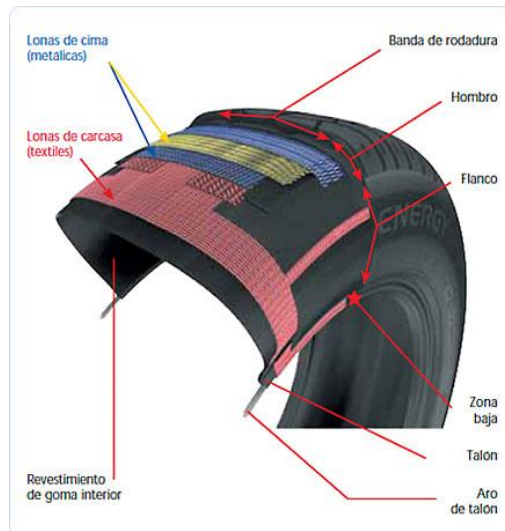
Figura 2.63. Partes que componen el neumático.
