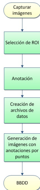
Figura 4.2: Diagrama de flujo del proceso de elaboración la base de datos.
