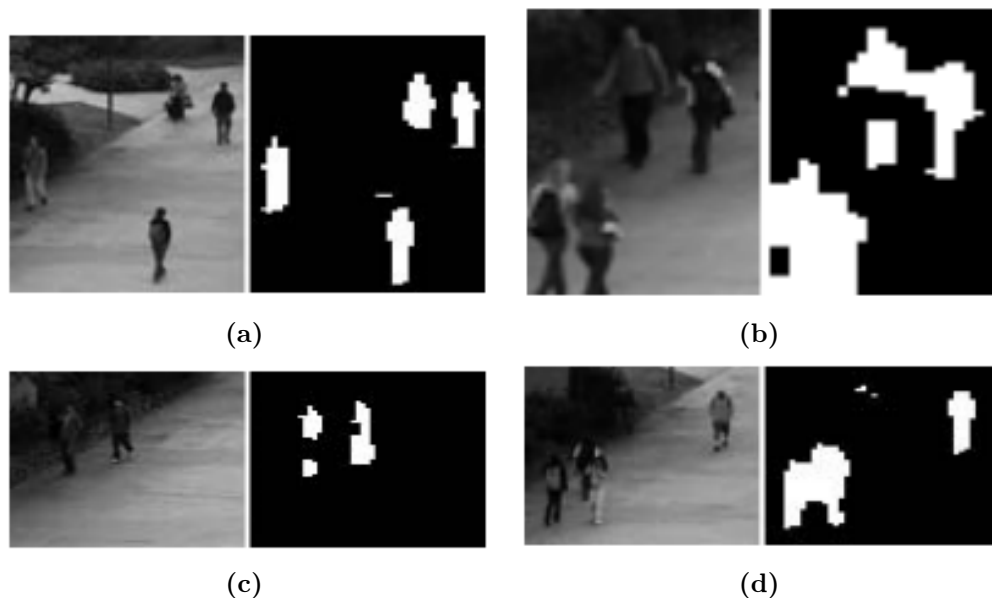
Figura 2.3: a) Extracción correcta de los individuos, con ruido adicional (es decir, una pequeña barra cerca del centro). b) Persona (arriba, centro) se fragmenta en dos manchas, una de ellas se fusiona con otra mancha cercana. c) Persona (izquierda) se fragmenta en dos manchas. d) Persona (arriba, centro) se funde con el fondo dejando pocos píxeles de primer plano. Esta persona es apenas visible para el ojo humano. (Imagen tomada de [22])
