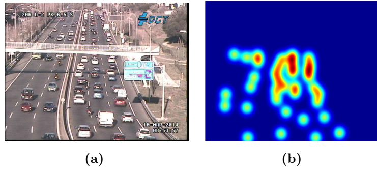
Figura 5.11: a) Imagen original. b) Gaussiana correspondiente con la anotación.
