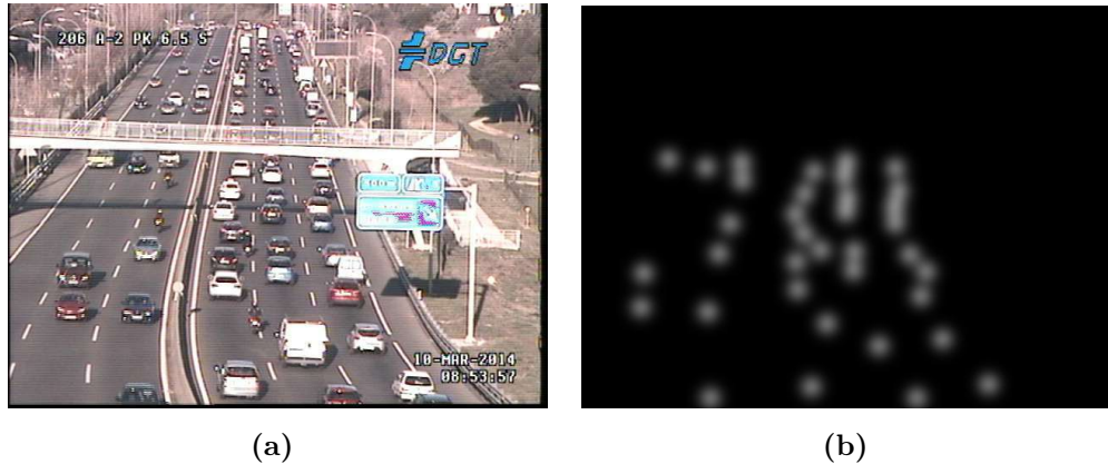
Figura 5.4: a) Muestra la imagen original de los vehículos. b) Se observan las respectivas Gaussianas para la anotación de los Vehículos.
