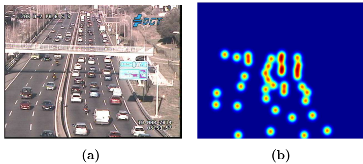
Figura 5.7: a) Imagen original. b) Gaussiana correspondiente con la anotación.
