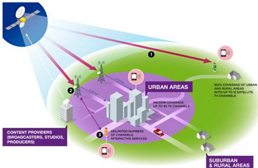
Figura 7:ejemplo de estructura Solaris Mobile en banda-S [7]
