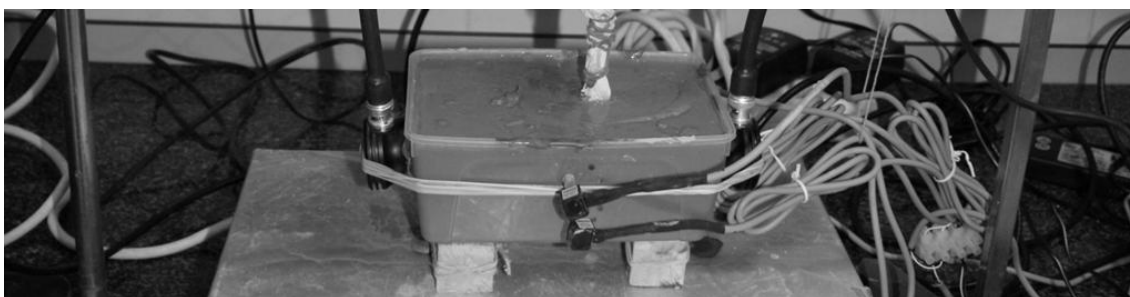
Fig. 30. Detalle de los tubos embebidos en la muestra conectados al sensor.
