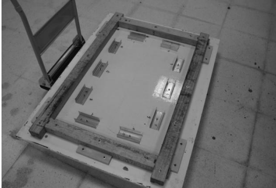
Fig.4 Losa Kraai modificada.
