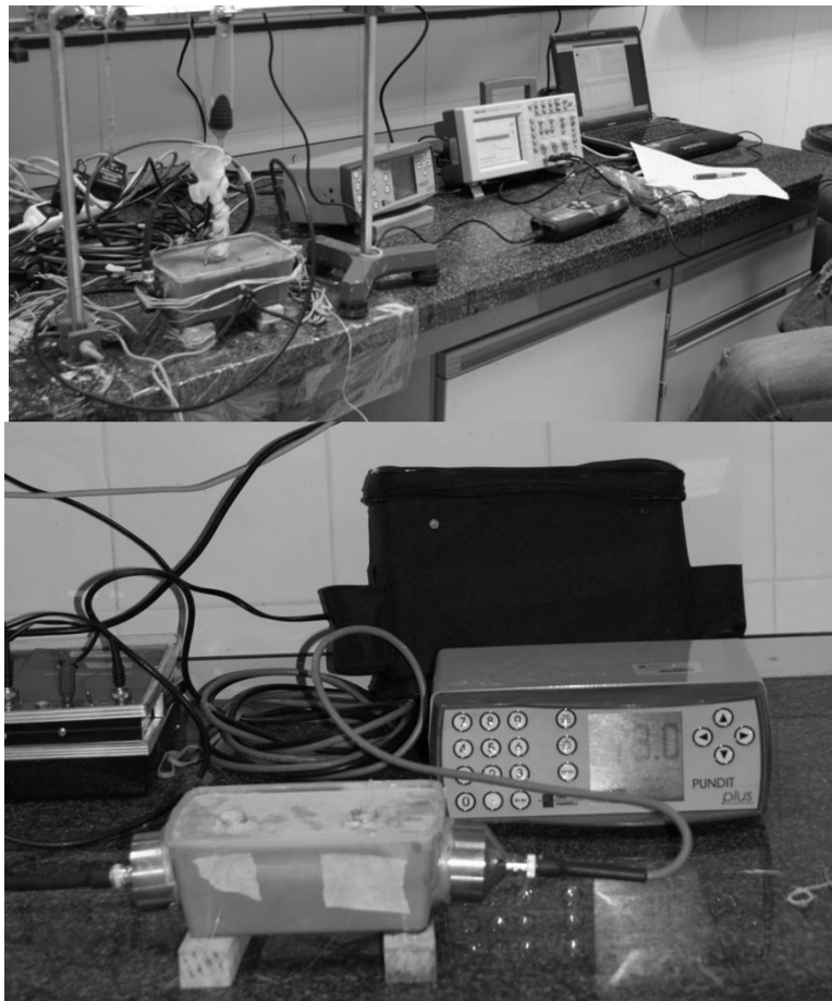
Fig. 27. Montaje de ensayo de UPV para p-wave.
