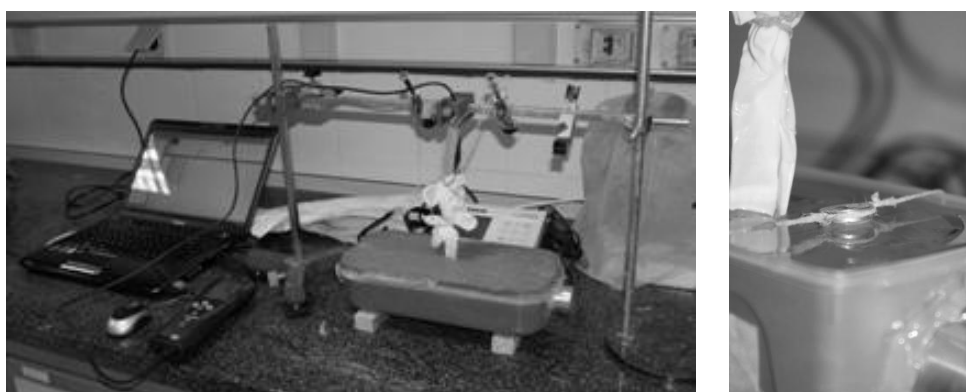
Fig. 26. Montaje de medición de temperatura.
