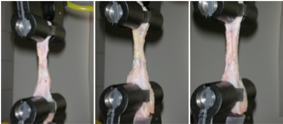
Figura 31: Imagen de Tensiómetro INSTRON modelo 3342 (Instron Corp., Canton, MA, USA) (Arriba), y de la forma de colocación de la muestra para el estudio de la resistencia (Abajo).
