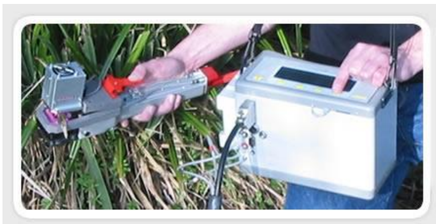
Figura I.15. Analizador de gases en el infrarrojo modelo LC Pro + de ADC BioScientific Ltd. (Herts, Inglaterra) de sistema abierto como el utilizado en esta Tesis.
