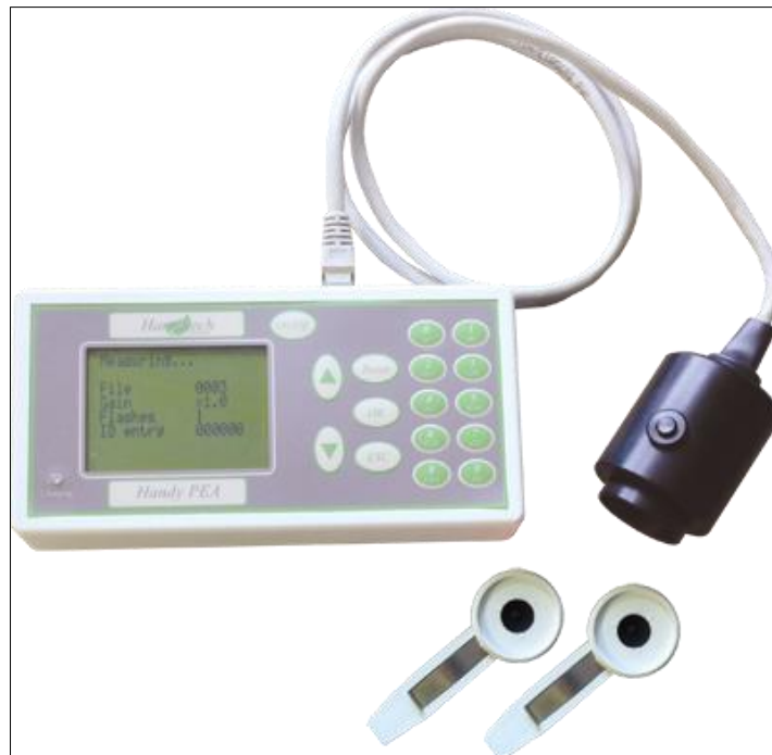
Figura IV.2. Fluorímetro de fluorescencia continua Handy PEA (Hansatech Instruments, UK) con los clips para hojas, como el empleado en esta Tesis.
