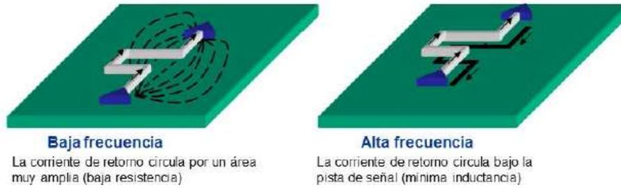
Figura 110: Diferencia de alta frecuencia y baja frecuencia
