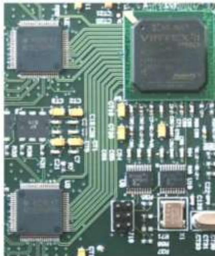
Figura 44: Líneas diferenciales de un PCB
