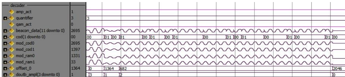
Figura 5.29: Simulación del bloque decodificador con señal APK.
