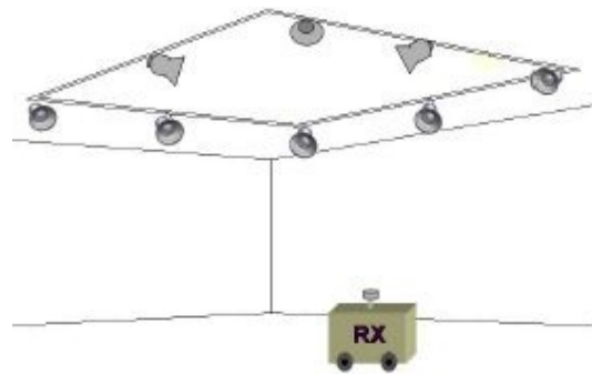
Figura 3.23: Despliegue de balizas y móviles a posicionar 13 .
