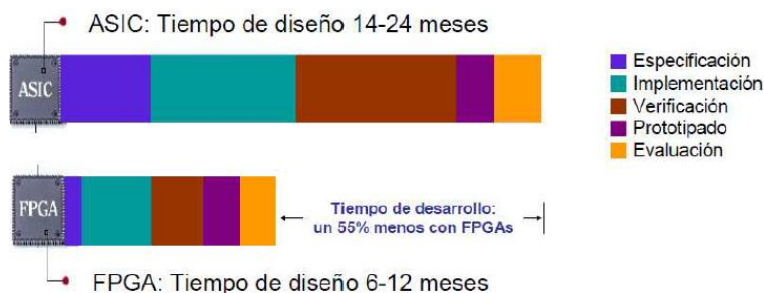
Figura 3.13: Diferencias de tiempo de desarrollo entre un ASIC y una FPGA 11 .
