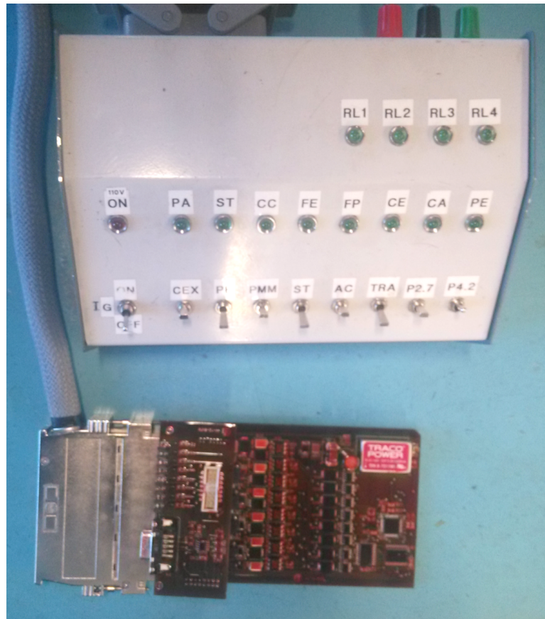
Figura 5.48: Comunicación maestro-esclavos por bus CAN
