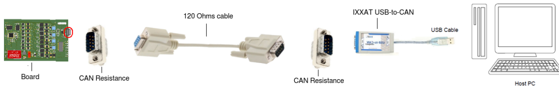
Figura 7.11: Conexionado de los elementos
