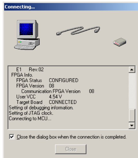
Figura 7.4: Proceso de comunicación entre tarjeta y PC
