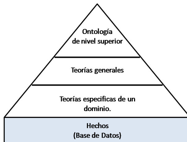
Figura 4.6: Modelo de Capas OpenCyc para una base de conocimiento
