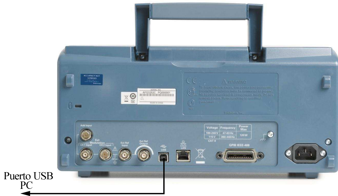
Figura A.2: Conexión del PC con el AFG.
