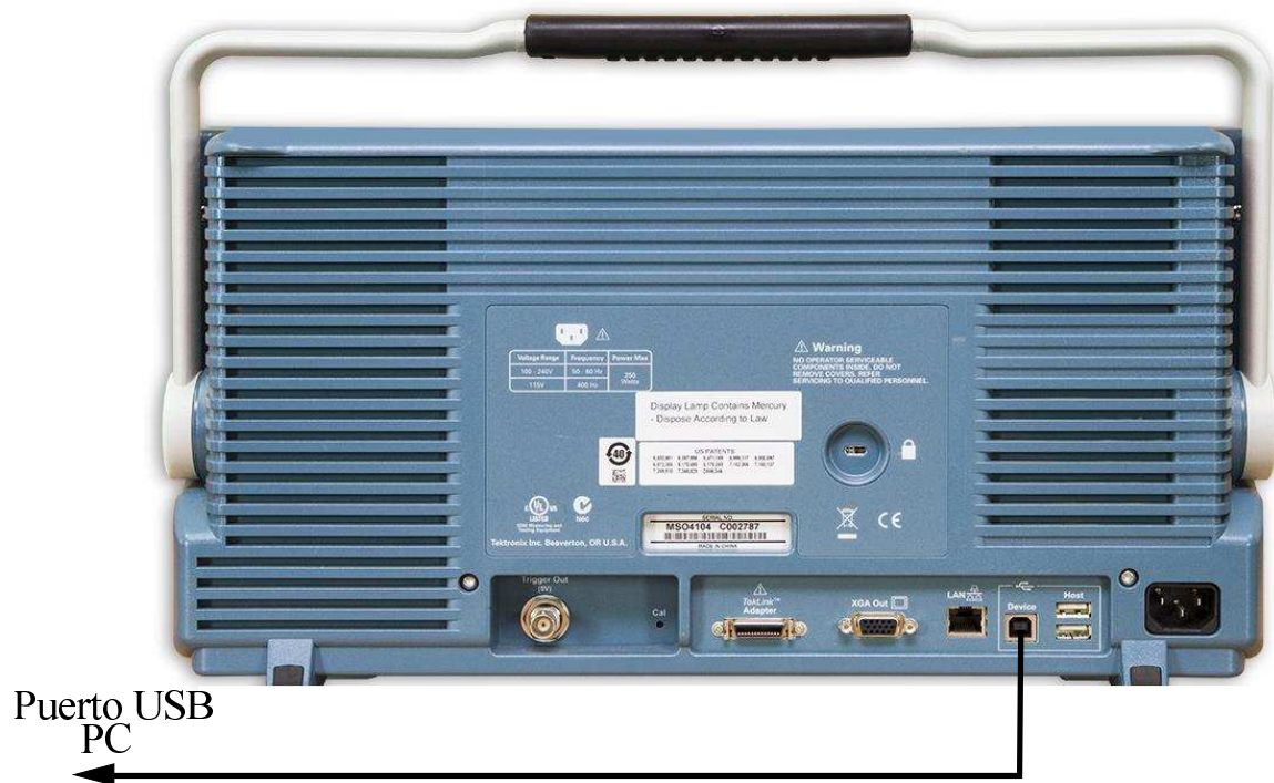
Figura A.3: Conexión del PC con el osciloscopio.
