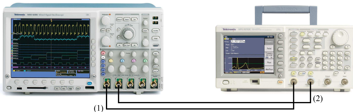
Figura A.4: Conexión del AFG con el osciloscopio.
