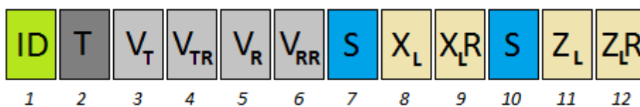
FIGURA 2.16 Estructura del Datagrama de Velocidad del TCP, herramienta y limitaciones
