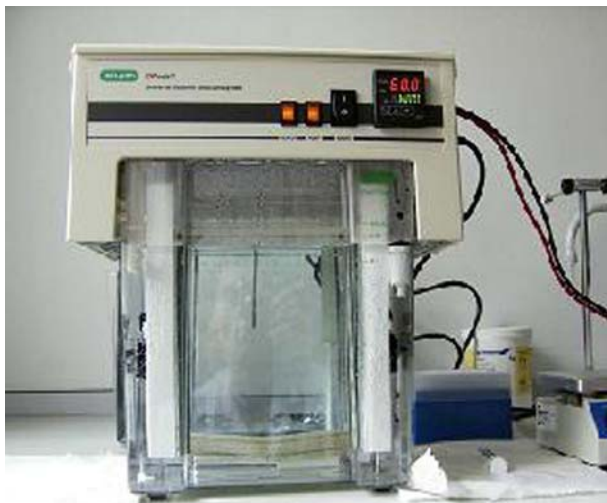
Figura 2.10. DC Code Universal Mutation Detection System para la realización de la DGGE
