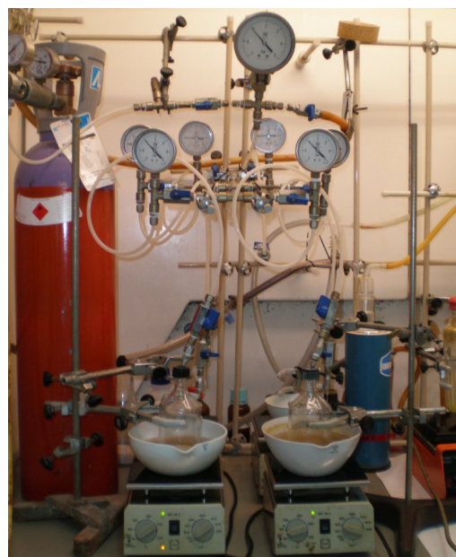
Figura 7. 15. Sistema utilizado en esta Memoria para las pruebas de polimerización de etileno.
