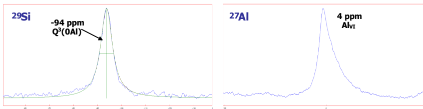
Figura a. 12. Espectros de 29 Si y 27 Al MAS-NMR de la MMt1/NH 4 .
