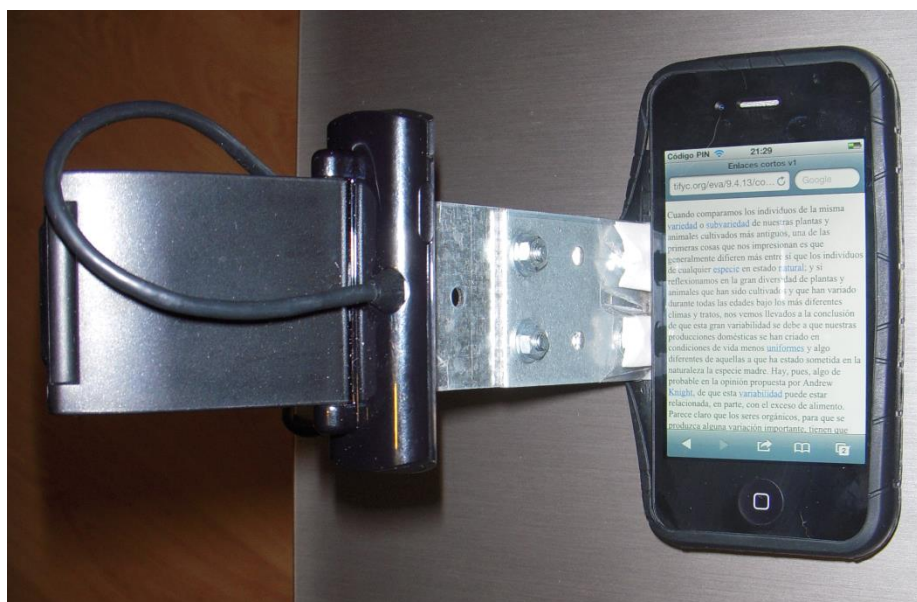
Figura 1. Mecanismo utilizado para grabar las interacciones del usuario en los experimentos llevados a cabo
