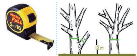
Figura 7. Medición de diámetros: aparato de medida utilizado (flexómetro) y esquema de procedimiento
