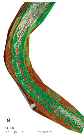
Figura 47. MDT y perfil longitudinal del lecho tras el ensayo de transporte sedimentológico
