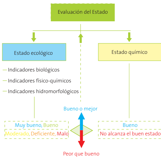
Figura 1. Esquema explicativo sobre la determinación del Estado de las masas de agua superficiales, según la DMA
