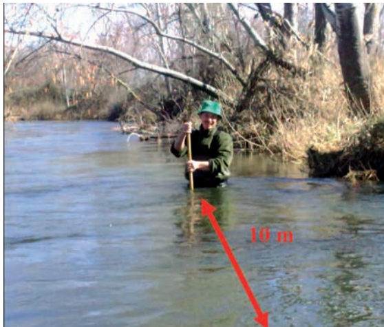
Figura 6. Procedimiento de muestreo biológico Kicking-net
