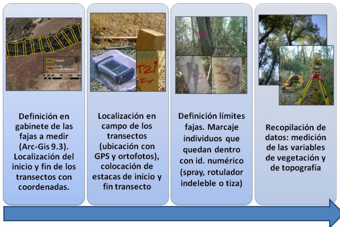
Figura 6 Procedimiento en campo
