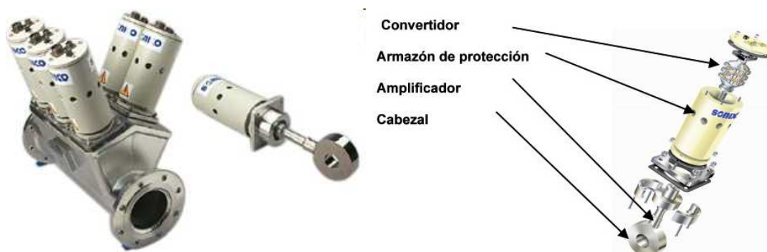
Figura 9. Reactor Sonix™: exterior y detalle de los componentes de un cabezal.
