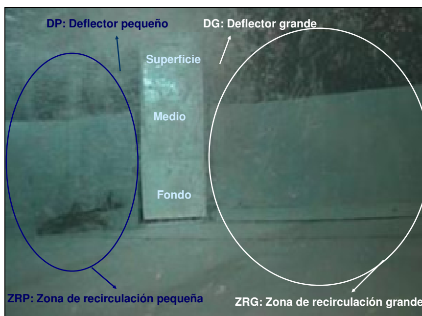
Figura 8. Imagen obtenida por una videocámara sumergida. Se ha realizado una representación de las dos zonas de recirculación, de los dos deflectores (grande y pequeño) y de la altura a la que puede pasar un pez por la hendidura (superficie, medio y fondo).
