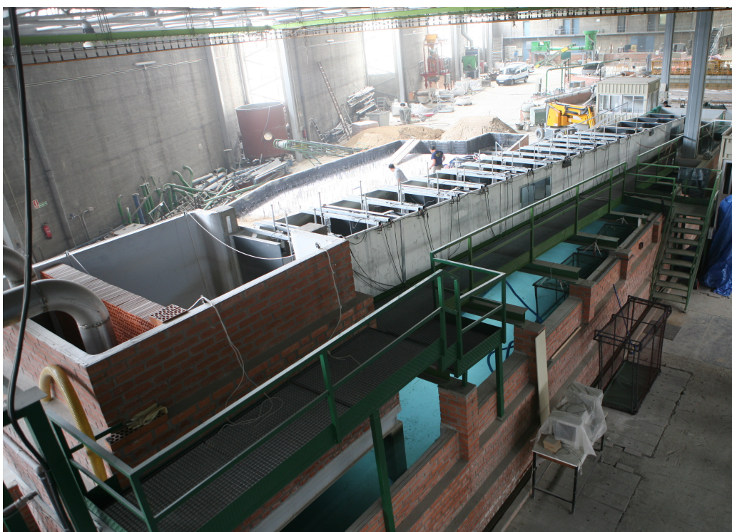
Figura 1. Modelo físico de la escala de peces en el Laboratorio de Hidráulica del CEH
