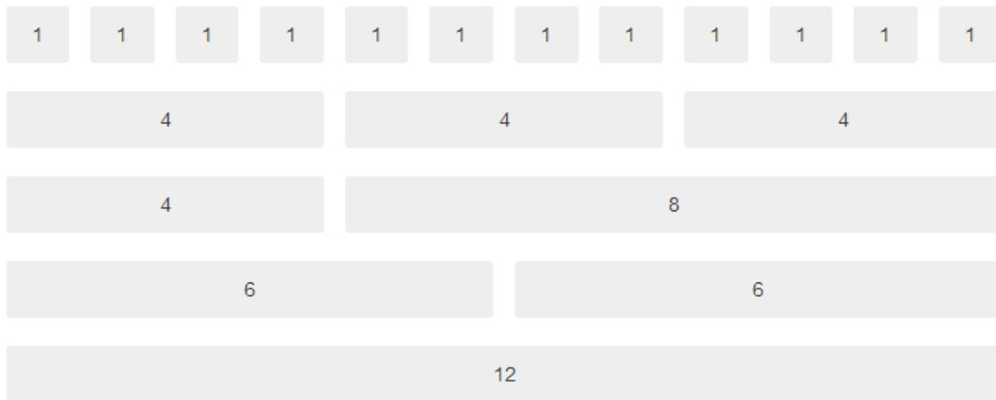
*Ilustración 56 Sistema de Columnas de Bootstrap*
