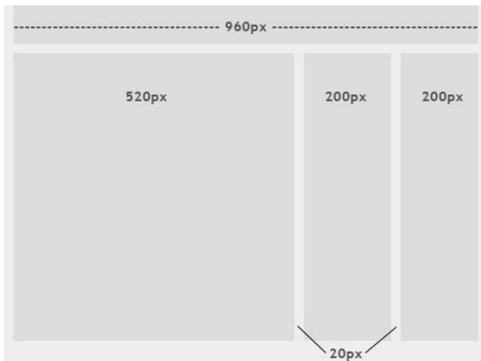
Ilustración 5 Layout de Ancho Fijo (Fuente: <http://coding.smashingmagazine.com/>)
