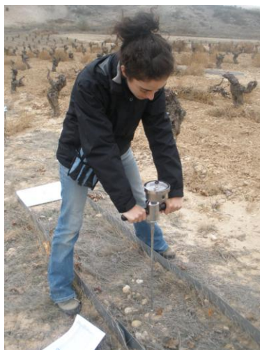
Fotografía 1.21. Detalle de medición de la resistencia a la penetración del suelo con el penetrómetro en una de las parcelas de Brachypodium distachyon en otoño en el viñedo de Villaconejos
