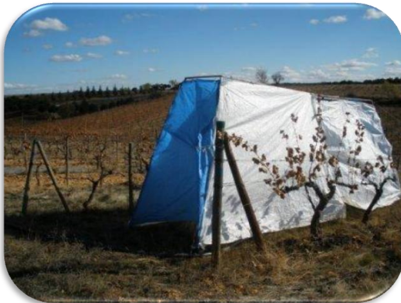
Simulador de lluvia durante la simulación realizada en otoño en el viñedo de Campo Real
