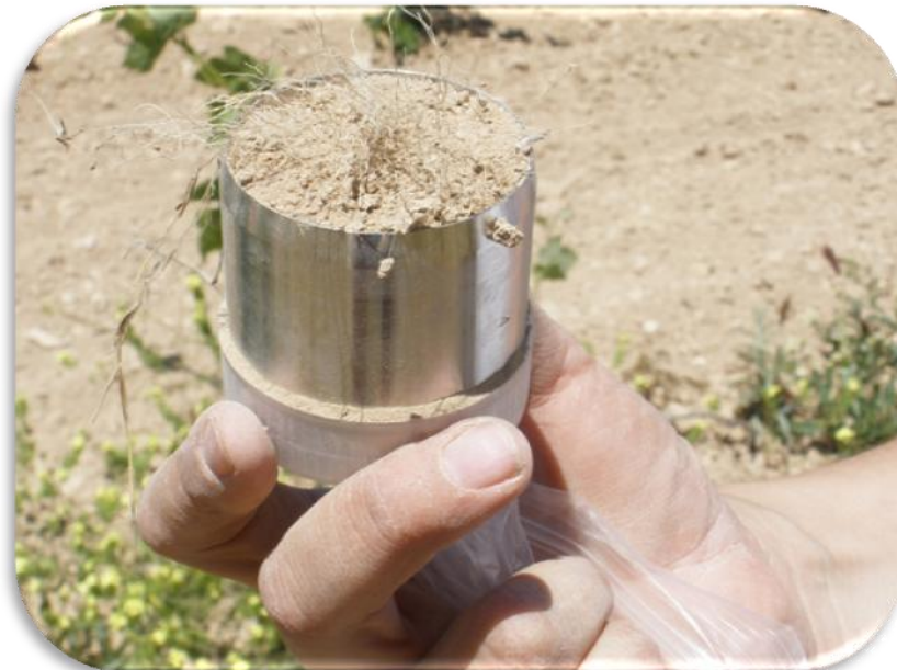
Muestra inalterada tomada en el viñedo de Belmonte de Tajo
