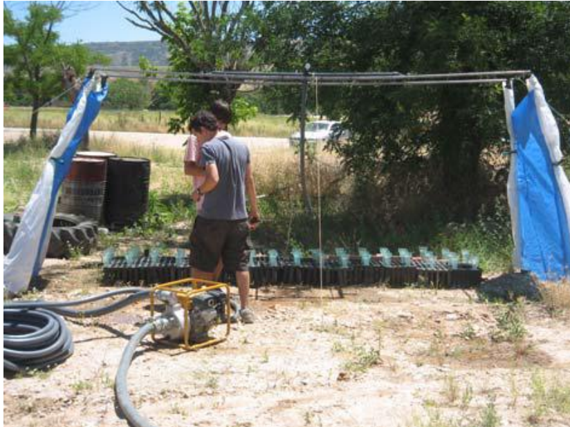
Fotografía 1.16. Ensayo de la calibración del simulador de lluvia
