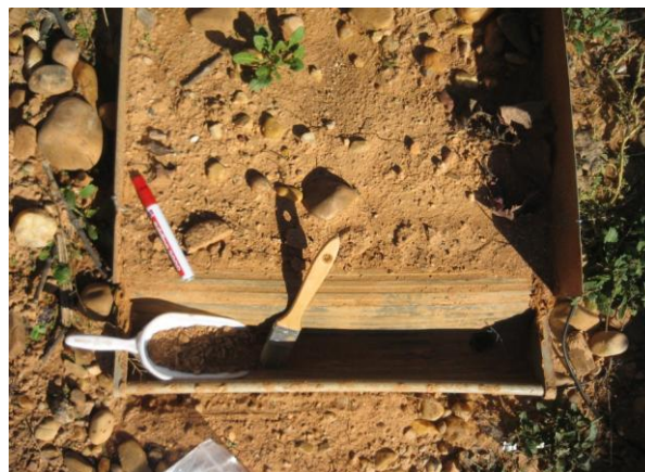
Fotografía 1.13. Detalle del canalón donde se recogía el sedimento durante uno de los muestreos
