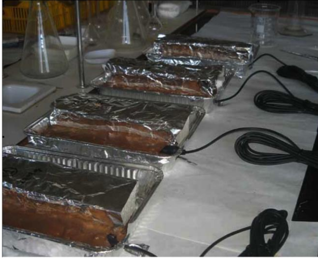
Figura 1.5. Calibración de los sensores ECH 2 O en laboratorio para cada tipo de suelo. A la derecha, ejemplo de los ajustes obtenidos en el suelo de Campo Real en el proceso de calibración, con suelos obtenidos de 0-10 y a 30-35 cm de profundidad.
