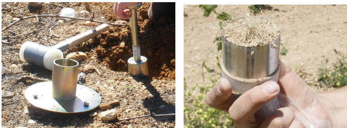
Fotografía 1.18. Detalle de la toma de muestras inalteradas en campo. Cada cilindro disponía de una tapa superior y otra inferior (foto derecha con tapa inferior) para evitar pérdidas de material en el transporte al laboratorio.
