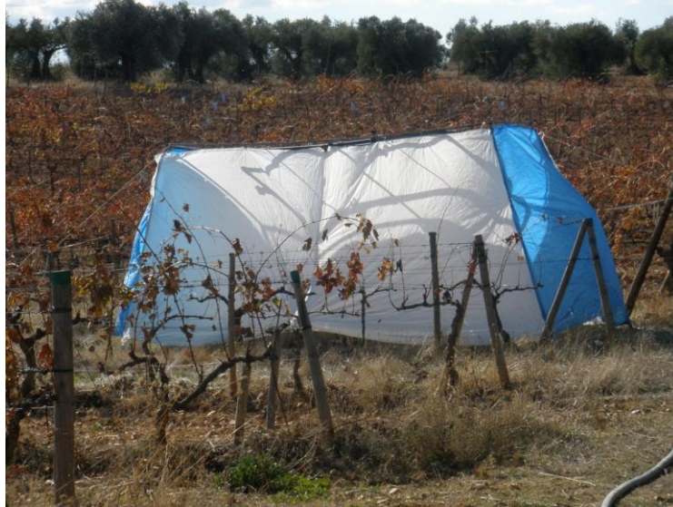
Fotografía 1.14. Disposición del simulador de lluvia en el centro de la calle del viñedo de Campo Real. Se observan las lonas para proteger del viento la lluvia simulada.
