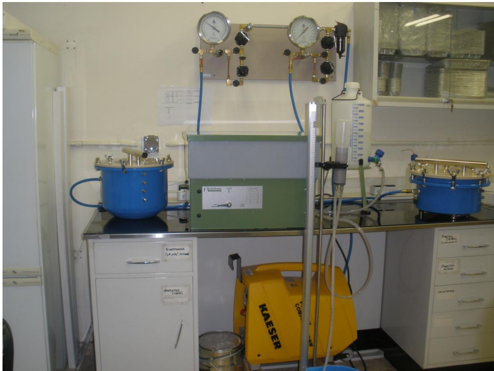
Fotografía 1.19. Sistema de humectación y extracción de la humedad en pasos sucesivos. Se observan dos ollas de color azul a ambos lados de la caja de arena, en verde en el centro. Sobre ella los manómetros para controlar la presión de la extracción de agua de las ollas.
