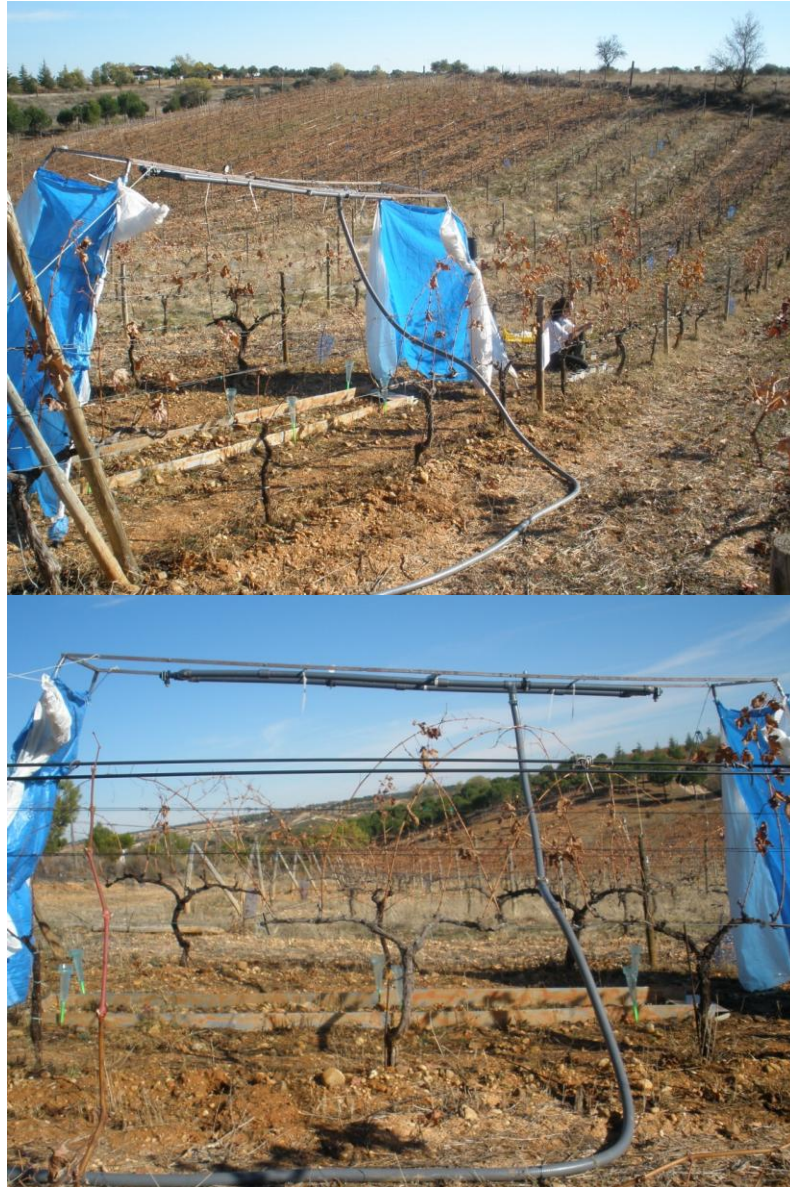
Fotografía 1.17. Superior, vista panorámica del simulador de lluvia instalado sobre una parcela de S. cereale en verano. Se observan los pluviómetros colocados a intervalos regulares para verificar las condiciones de homogeneidad e intensidad de la lluvia en cada ensayo. Inferior, vista lateral, las dos boquillas están situadas en los extremos de la tubería que conforma un circuito cerrado de agua.
